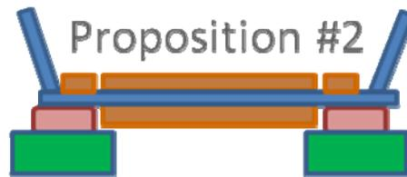
Cette modification soulève cependant une interrogation au niveau du « shear lag » ou « décalage en cisaillement » de la part des concepteurs et nous démontrons par calcul que cette proposition est néanmoins adéquate et c'est celle que nous retenons.
