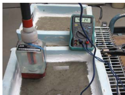
Mesure du potentiel de corrosion sur les dalles de laboratoire
