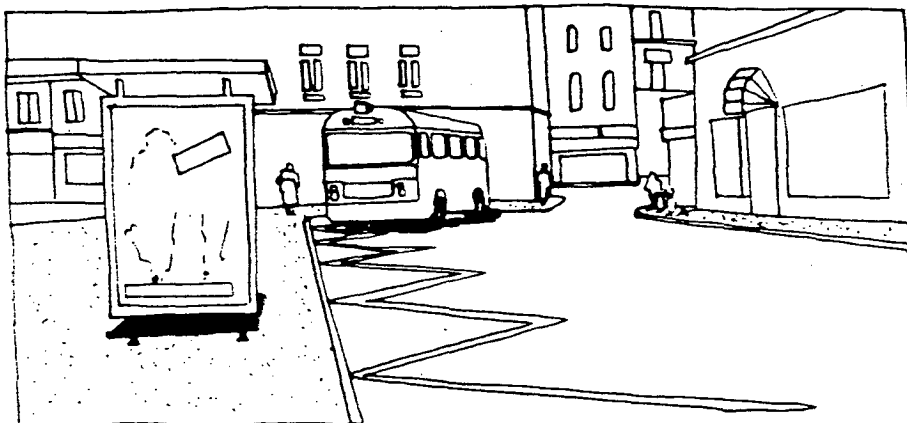
Marquage en zigzag sur toute la longueur nécessaire à l'arrêt et aux manœuvres du bus
