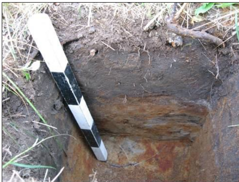
Photo 8 : Projet n° 154-07-1457, paroi d'un sondage montrant un podzol déstructuré, chaînage 8+150, route 371, municipalité de Saint-Gabriel-de-Valcartier, direction nord (photo n° 154-07-1457-20)
