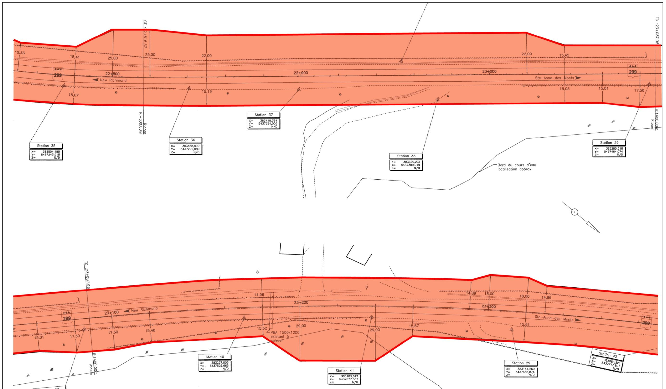
Figure 5 : Projet n° 154-01-0090, localisation de l'emprise, chaînage 22+760 à 23+380, route 299, municipalité de Sainte-Anne-des-Monts (source : MTQ, plan n° CH-6308-154-01-0090-4)
