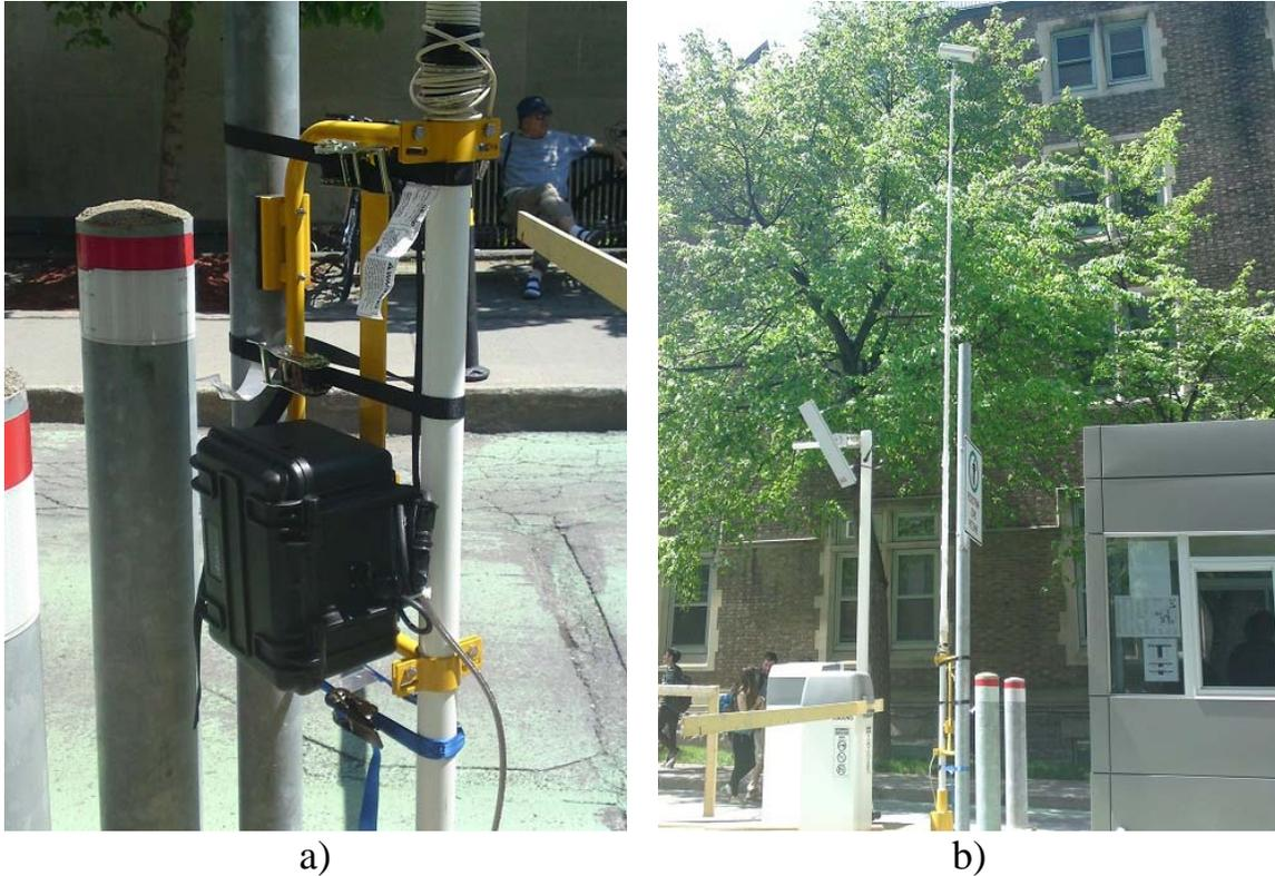
**Figure 17 – Équipement MioVision modifié, version 1.0: a) installation de la base, b) avec mât étendu.**
