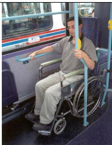
Figure 25 Système de retenue orienté vers l'arrière, BC Transit
