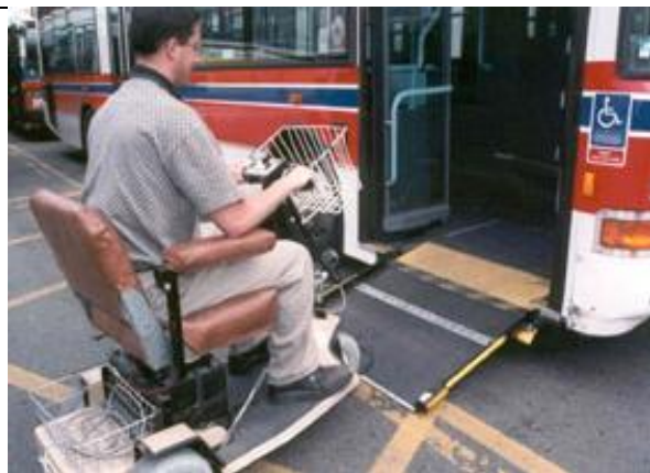
Figure 12 Scooter s'engageant sur une rampe d'autobus à plancher surbaissé
