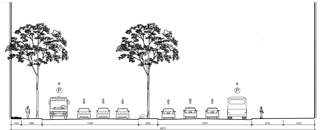
COUPE 30 LE BOULEVARD RENÉ-LÉVESQUE EST LE PROFIL EXISTANT ENTRE LES RUES SAINT-DENIS ET BÉRI
