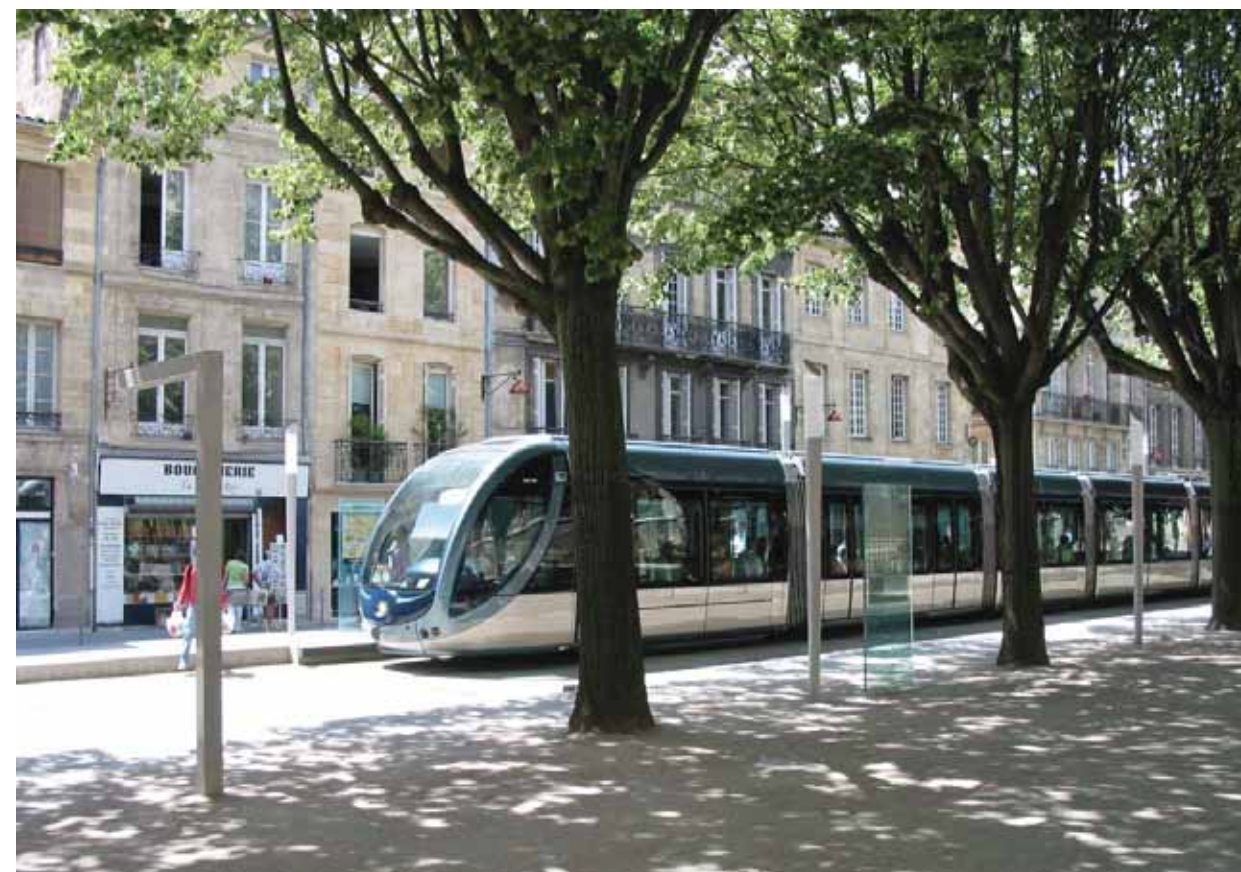
BORDEAUX - PLACE PEY-BERLAND LE QUAI SE CONFOND AVEC LA PLACE PUBLIQUE, AUCUN MARQUAGE NE LES DISTINGUE, SEUL LE MOBILIER DE STATION PERMET D'IDENTIFIER L'ARRÊT DU TRAMWAY
