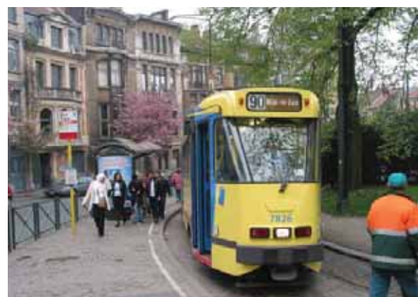
STATION EN COURBE À BRUXELLES : LA LACUNE ENTRE MATÉRIEL ROULANT ET QUAI EST VARIABLE LE LONG DE LA CAISSE DE LA VOITURE. CE MATÉRIEL ROULANT CONÇU AVANT GUERRE AVAIT POUR CELA PRÉVU DES PORTES EN EXTRÉMITÉ DE CAISSE.
