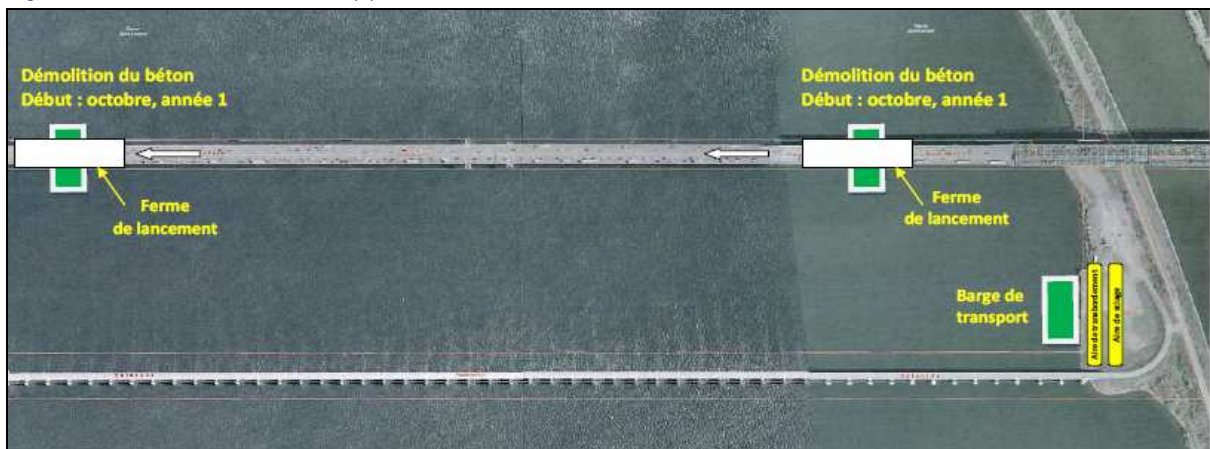
Figure 48 – Schéma illustrant deux (2) fronts de travaux de démolition des travées de béton
