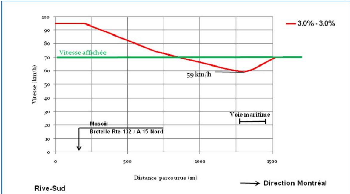
Figure 4.2: Vitesse théorique d'un camion (sans congestion) - tablier de 4 m d'épaisseur
