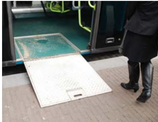
Rampe manuelle : observée dans les BHNS en Suède, Pays-Bas, Allemagne; souhaitée pour 2 raisons, faible demande de fauteuils roulants, contraintes plus forte dans le nord – elle est actionnée par le conducteur (même pour le bi-articulé de Hambourg).
