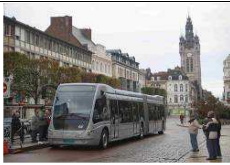
Le PHILEAS de Douais a des portes sur les deux côtés, vue sur portes à gauche
