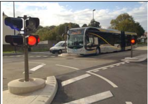
Nantes: le signal d'arrêt R24 dans tous les giratoires (le même pour le tram)
