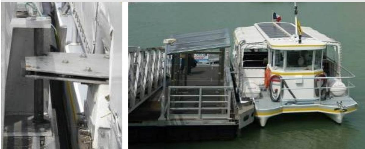
Illustration 8 - A La Rochelle, le système d'accroche automatique du Passeur ajouté au crochet de guidage remplace l'opération d'amarrage du bateau et permet de réduire le personnel à bord (un capitaine suffit). Photo : SYSTRA
