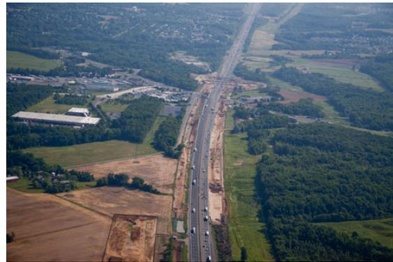
Une fois achevé, ce projet d'élargissement constituera une autoroute à 12 voies double (6 voies dans chaque direction), capable d'absorber l'augmentation de la circulation prévue d'ici 2032.
