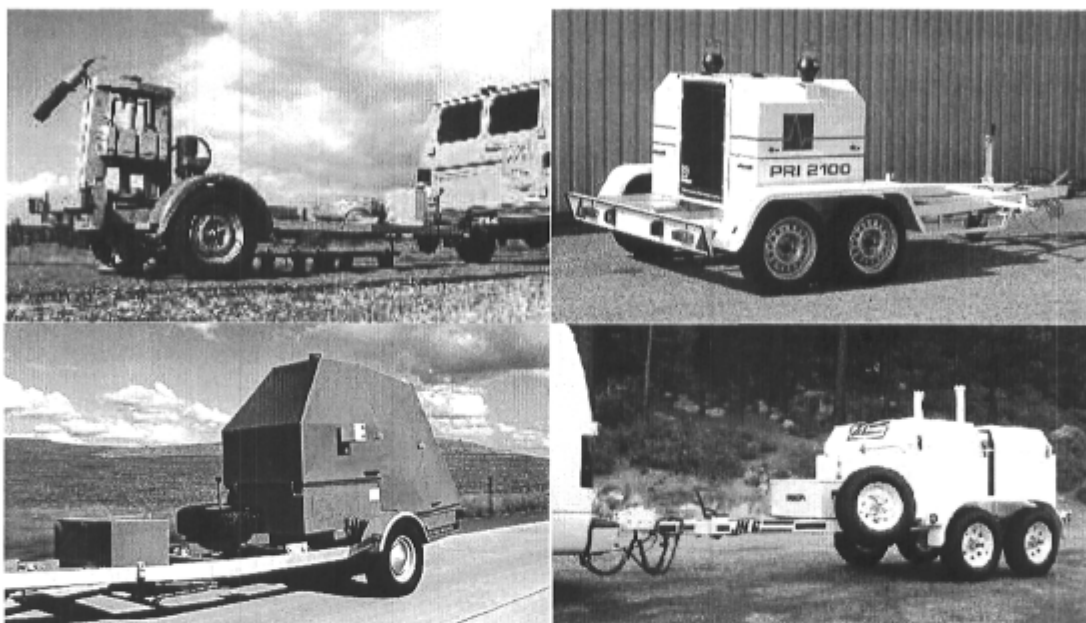
Figure 2.3 : a) FWD model 8000 de Dynatest, b) FWD modèle PRI 2100 de Carl Bro, c) KUAB 2m-FWD modèle 50 de KUAB, d) JILS-20-FWD de la compagnie Foundation Mechanics Inc.
