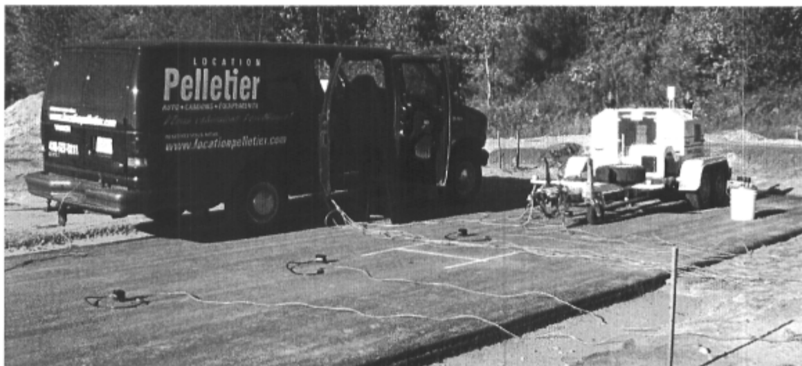
Figure 5.10 : Essais FWD réalisés sur la planche 2 à la sablière des Entreprises P.E.B. Ltée. avec des mesures indépendantes de l'accélération verticale à l'aide de six accéléromètres EpiSensor.
