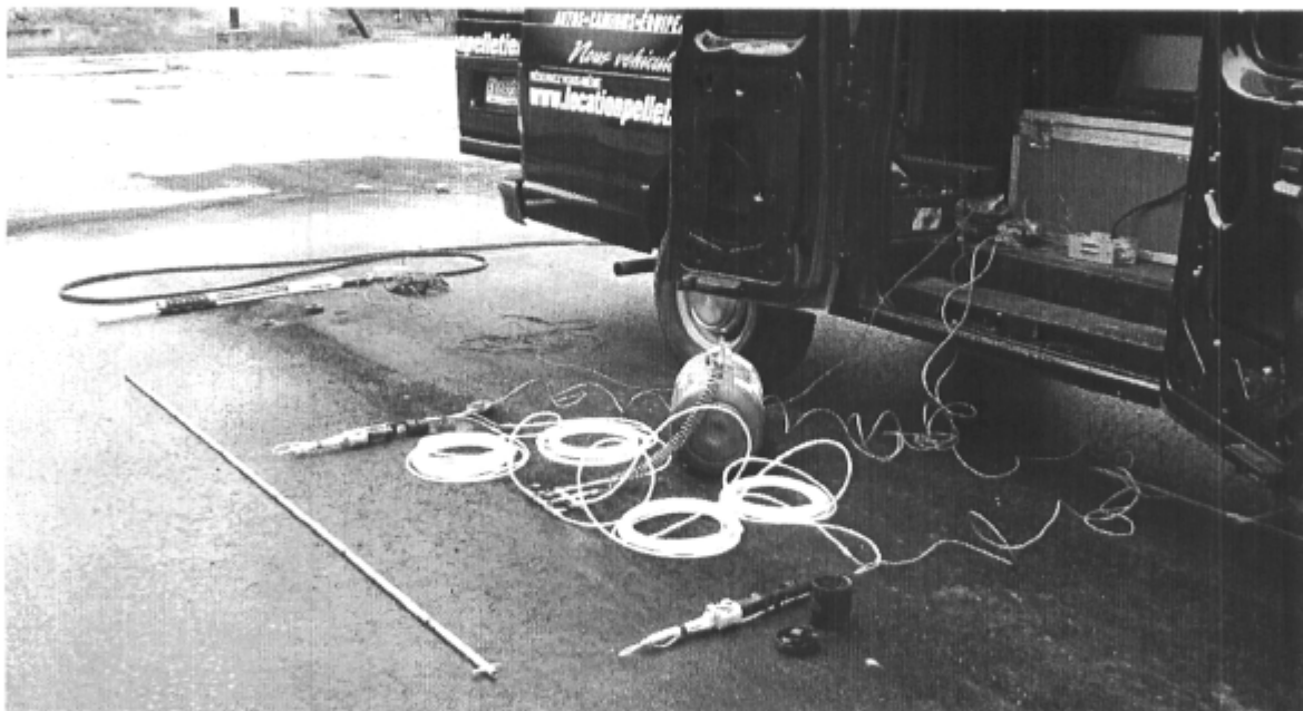
Figure 5.12 : Vue d'ensemble des appareils des essais cross-hole (la pompe hydraulique est à l'arrière dans la camionnette).
