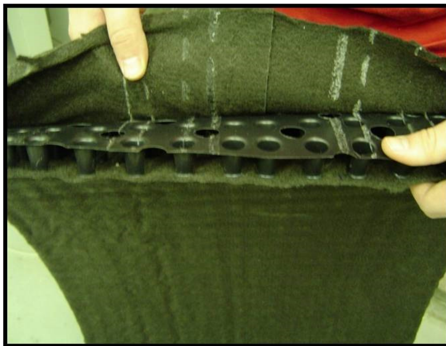
Figure 18. Drain thermique (tiré de Jorgensen et coll., 2008)
