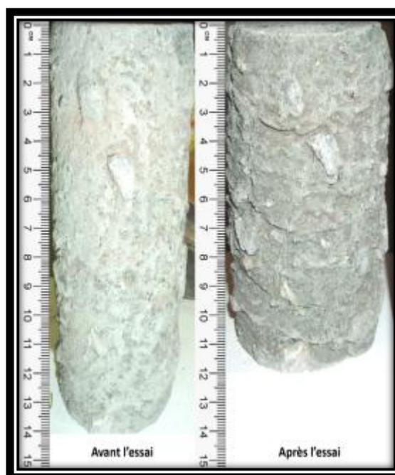
Échantillon avant et après essai de fluage
