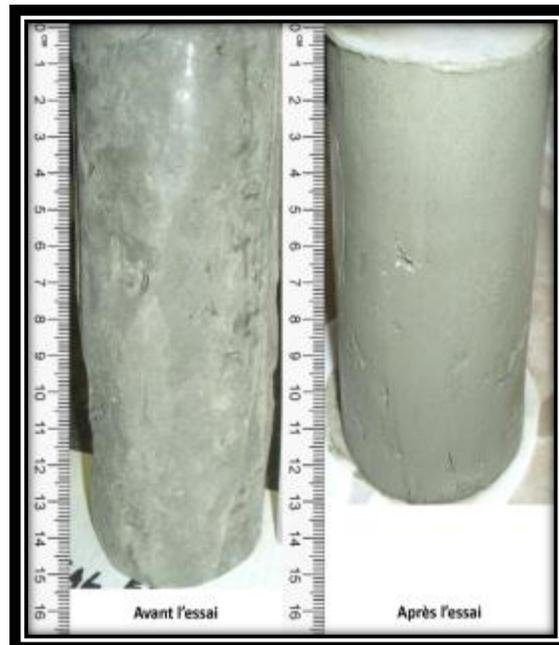
Échantillon avant et après essai consolidation
