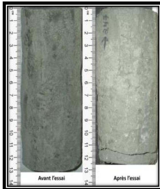
Échantillon avant et après essai de fluage
