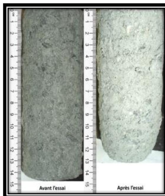
Échantillon avant et après essai de fluage
