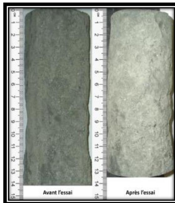
Échantillon avant et après essai de fluage
