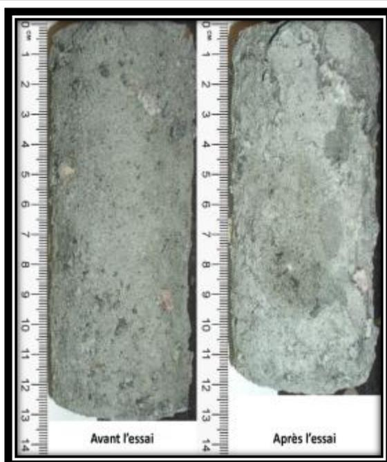
Échantillon avant et après essai de fluage
