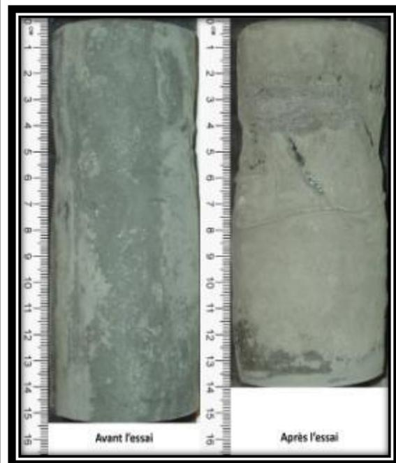
Échantillon avant et après essai de fluage
