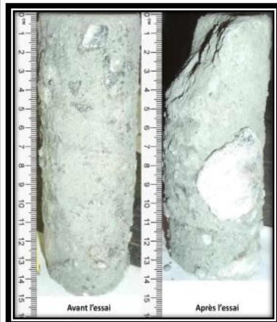
Échantillon avant et après essai de fluage
