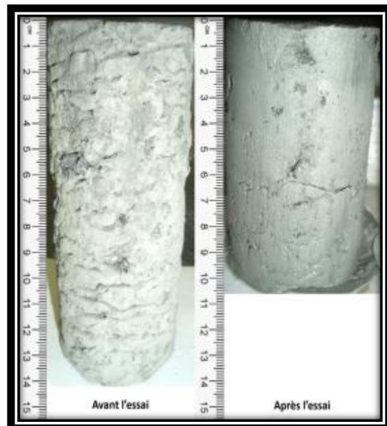
Échantillon avant et après essai consolidation
