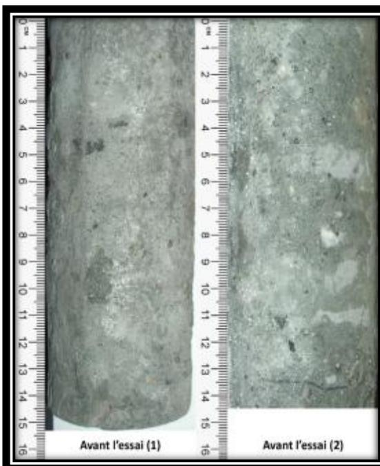
Échantillon avant l'essai de fluage
