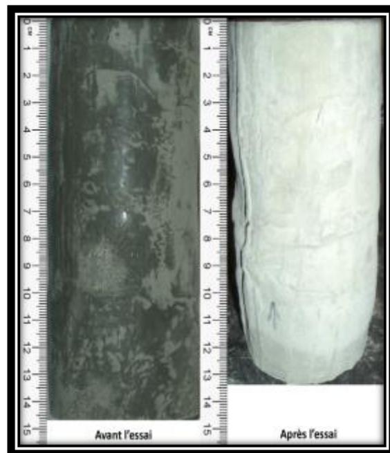
Échantillon avant et après essai de fluage
