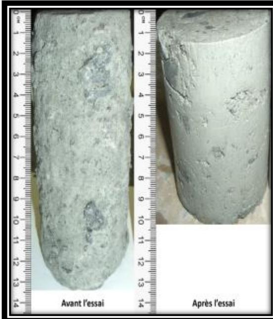
Échantillon avant et après essai consolidation au dégel
