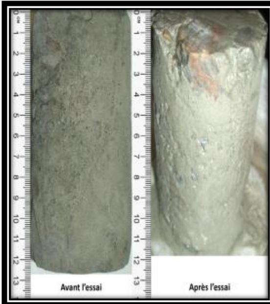
Échantillon avant et après essai consolidation au dégel
