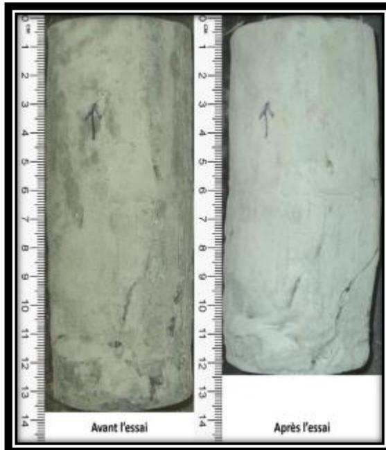
Échantillon avant et après essai de fluage
