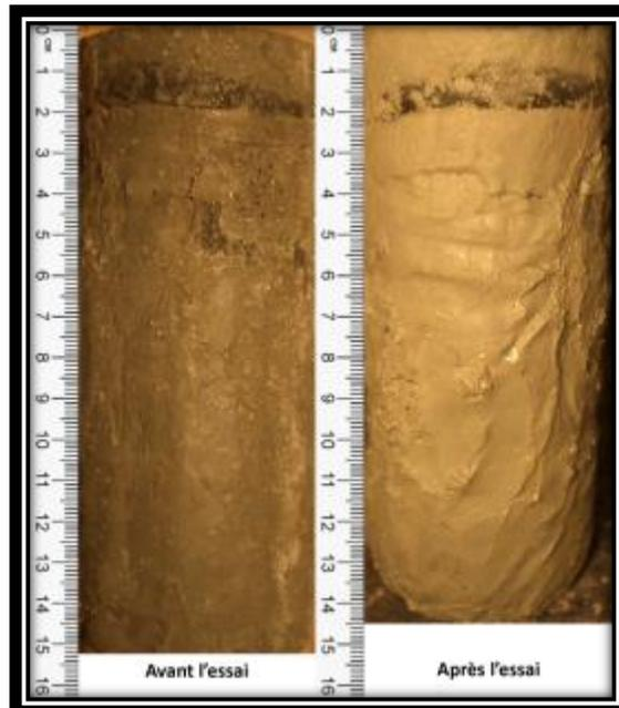
Échantillon avant et après essai de fluage
