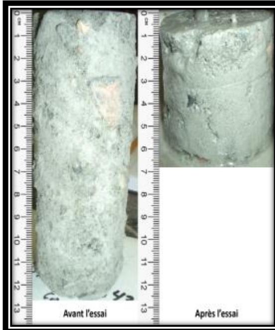
Échantillon avant et après essai consolidation au dégel
