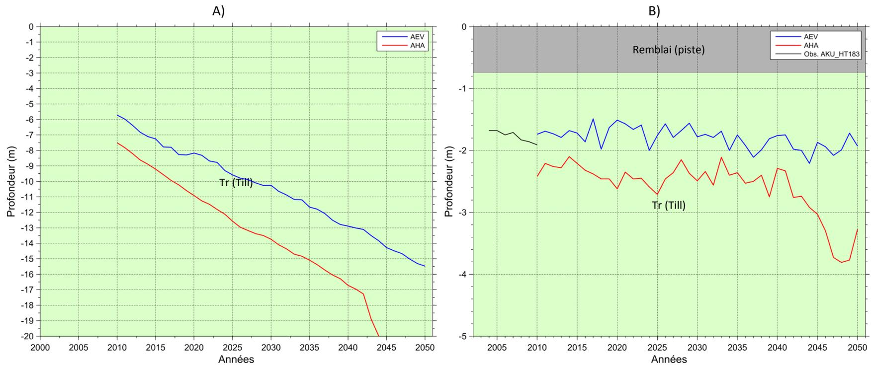
Figure 63: Projection de la variation de la profondeur du front de dégel en pied de remblai (A) et au centre-piste (B) pour la période 2011-2050, aéroport d'Akulivik, chaînage 5+960 m, vis-à-vis le câble HT-183.
