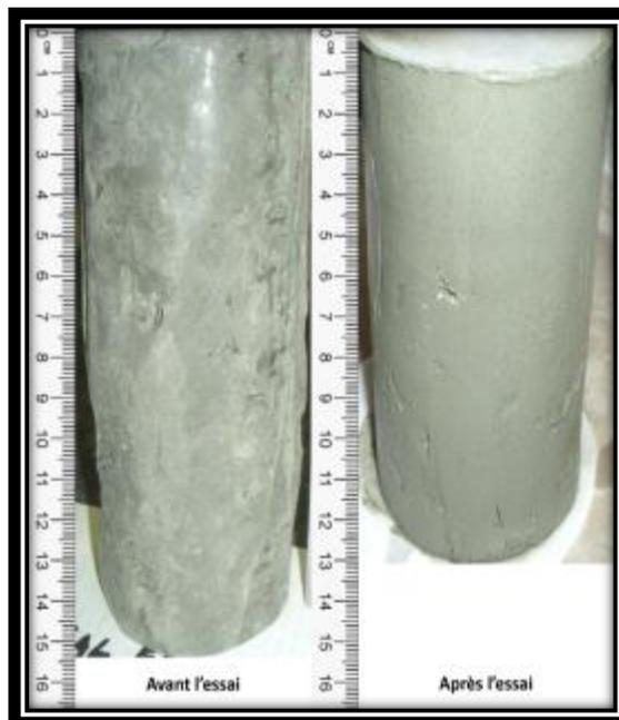
Échantillon avant et après essai consolidation
