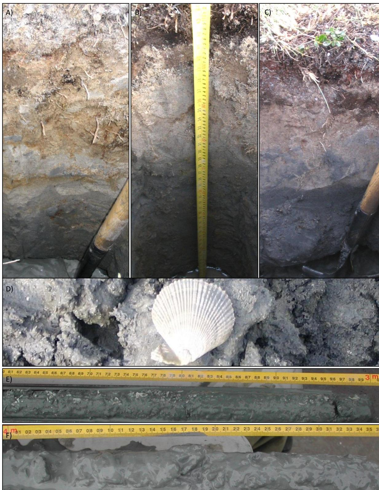
Figure 31 : Sondages INU\_T4 (A), INU\_T6 (B) et INU\_T7 (C) effectués à proximité de la piste d'Inukjuak (Figure 27A). B). D) Coquilles marines trouvée à l'intérieur des sédiments intertidaux (Mi) excavés au sondage INU\_T7. E) Sédiments intertidaux composés de silts inorganiques et sables très fins non plastiques (USCS : ML) prélevés au forage INU\_F4 entre 2,6 et 3 m (E) et 4 et 4,4 m (F) de profondeur.
