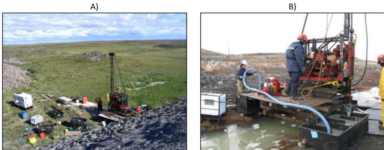
Figure 2 : A) Foreuse et accessoires requis pour le prélèvement d'échantillons de sols. B) Système de refroidissement des boues de forage.
