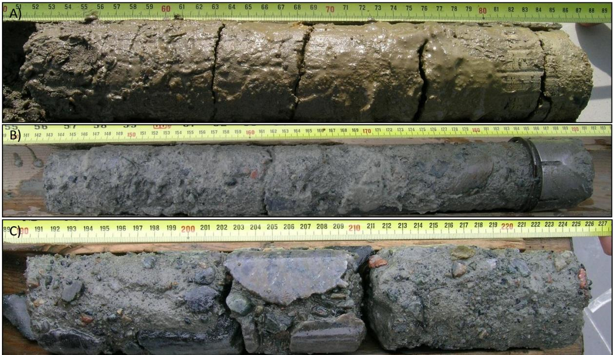
Figure 83 : Échantillons gelés prélevés au forage QUA-F2. A) Sable moyen à grossier brunâtre avec traces de silt (alluvions (AP)) prélevé entre 0,52 et 0,85 m de profondeur. Matériel hétérométrique non trié grisâtre (Till (T)) avec glace interstitielle prélevé entre 1,43 et 1,90 m (B) et entre 1,90 et 2,22 m (C) de profondeur.
