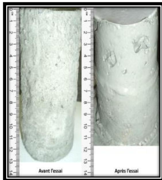
Échantillon avant et après essai consolidation
