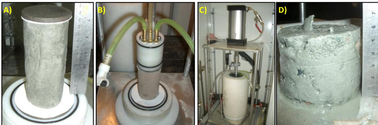
Figure 6 : A) Échantillon SAL\_F6\_290\_304 (SA) posé sur la base de la cellule. B) Piston reposant sur la pierre poreuse et l'échantillon. C) Montage de l'équipement dans une chambre à température contrôlée (+2 °C). D) Échantillon SAL\_F2\_343\_356 après consolidation au dégel.
