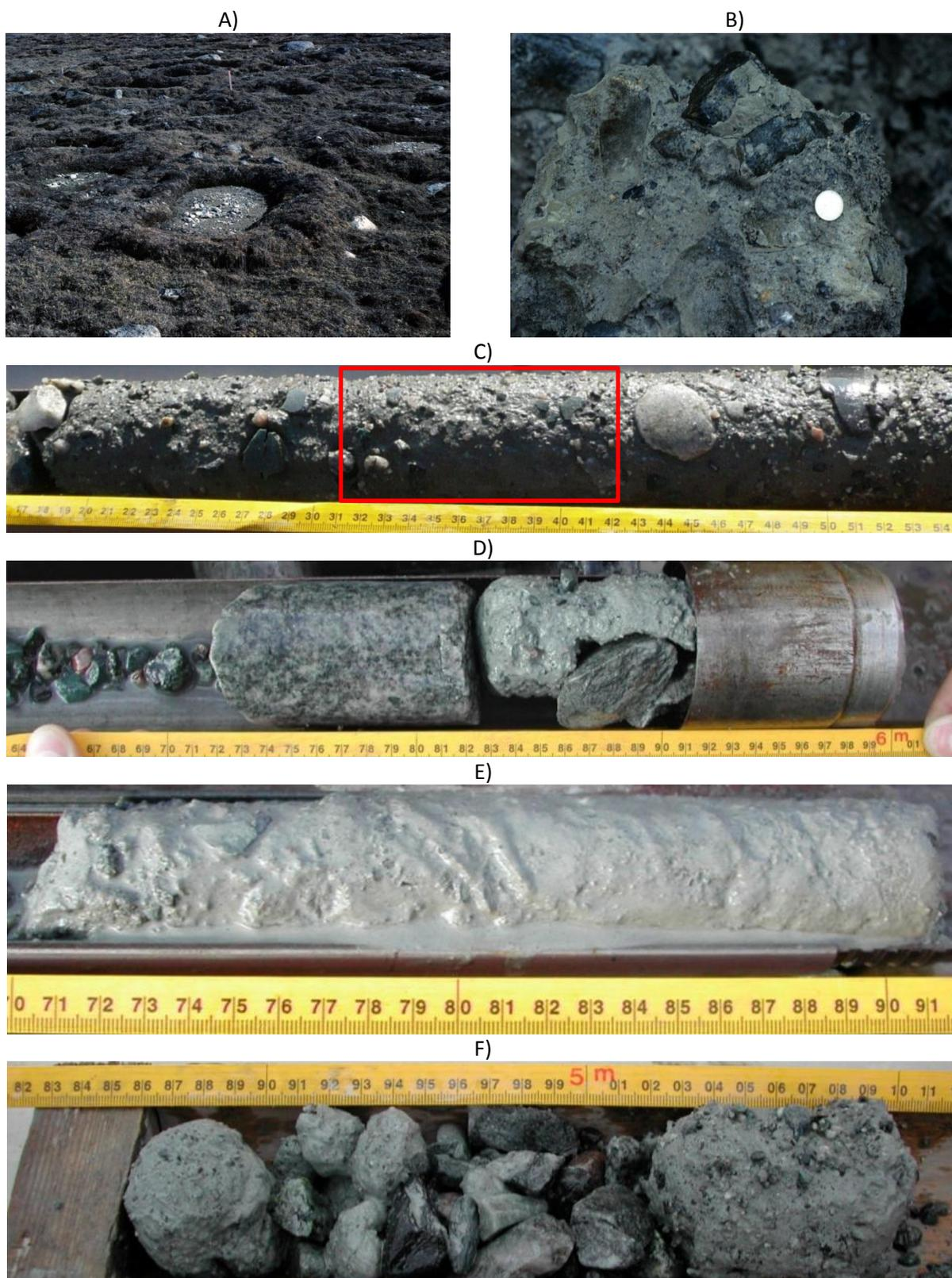
Figure 57: A) Ostioles à bourrelets dans le till qui traversent la mince couche de sédiments littoraux et pré-littoraux. B) Diamicton grisâtre (till) avec lentilles de glace millimétriques. Échantillons de till gelé prélevés entre : C) 4,16 m et 4,60 m (forage AKU\_F1), D) 5,80 et 6 m (forage AKU\_F2), E) 8,70 et 8,93 m (forage AKU\_F3) et 4,86 et 5,10 m (forage AKU\_F4). L'encadré rouge en (C) indique la section de la carotte qui a été soumise à un essai de consolidation au dégel.
