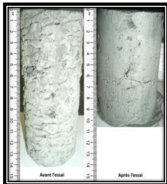
Échantillon avant et après essai consolidation
