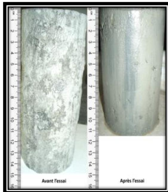
Échantillon avant et après essai consolidation
