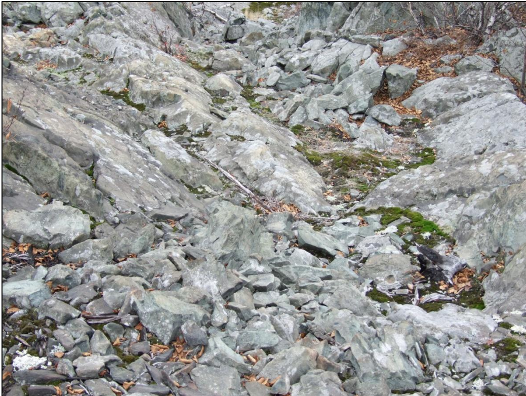
Photo 8 Chaînage 5+600, affleurement rocheux dans le centre ligne, plan rapproché sur la rhyolite fracturée
