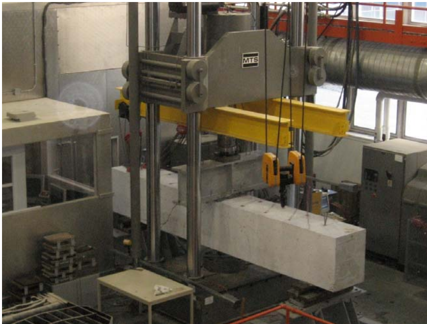
Figure 8 : Montage de l'essai de chargement 3 points (dalle type 3B)
