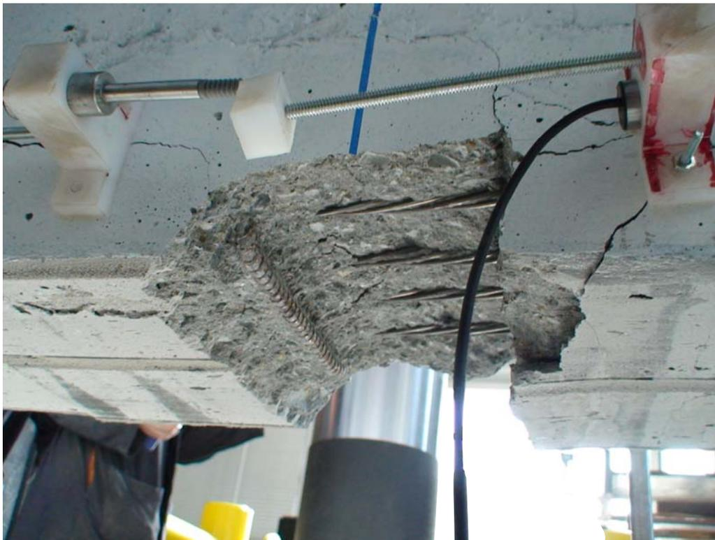
Figure 9.14 : Surface de rupture – plan d’initiation de rupture – L3L
