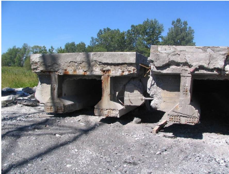
Figure 12.4 : Poutres prélevées en vue des essais
