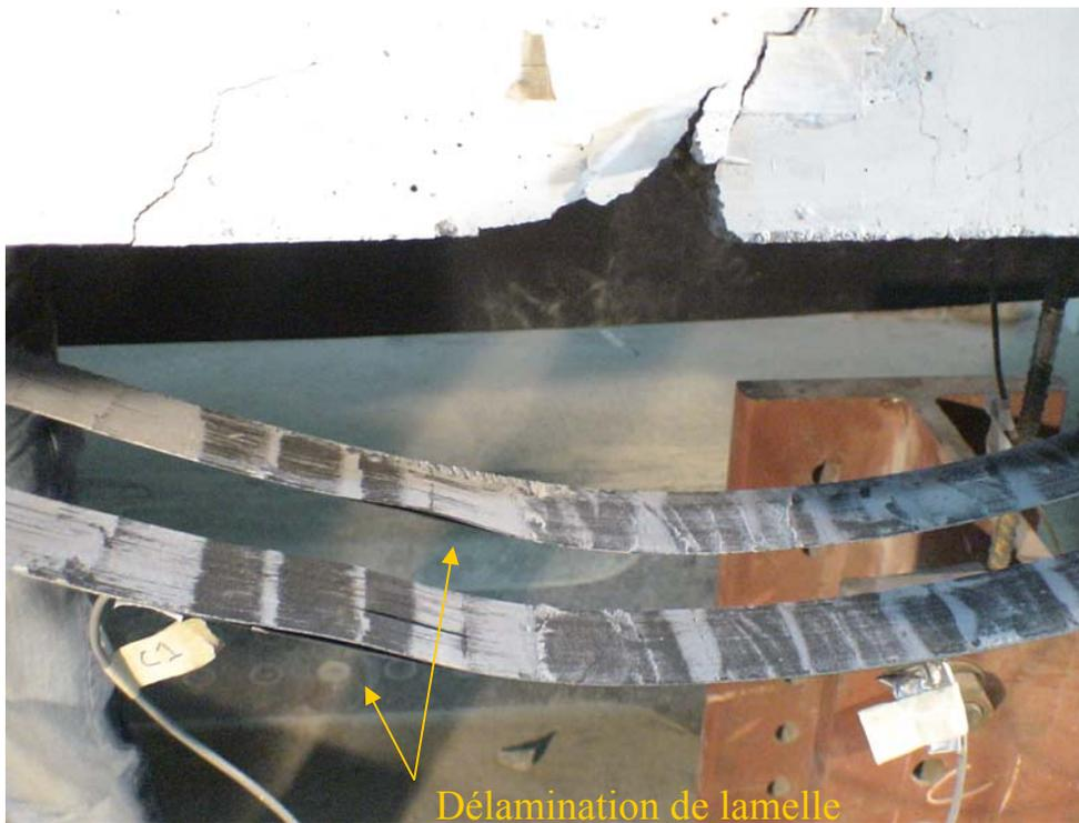
Figure 7.24 : Lamelles du composite après rupture
