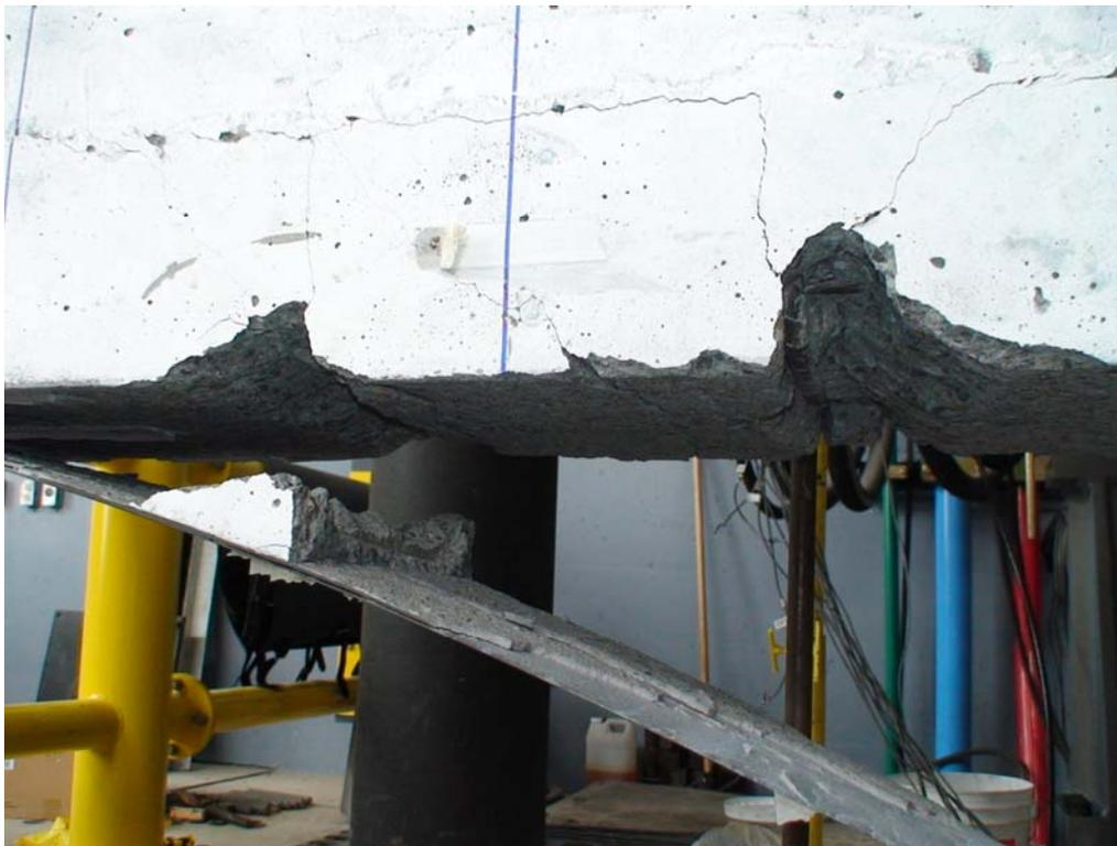
Figure 9.8 : État du spécimen L10 après la rupture
