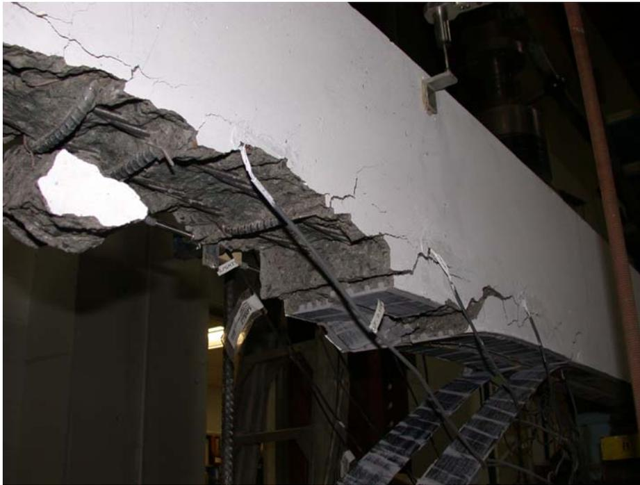
Figure 7.5 : Surface de rupture – plan de propagation de rupture
