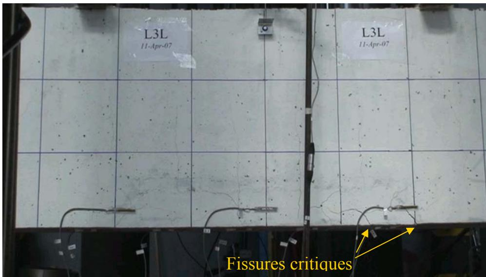
Figure 9.12 : Mécanisme de fissuration – L3L
