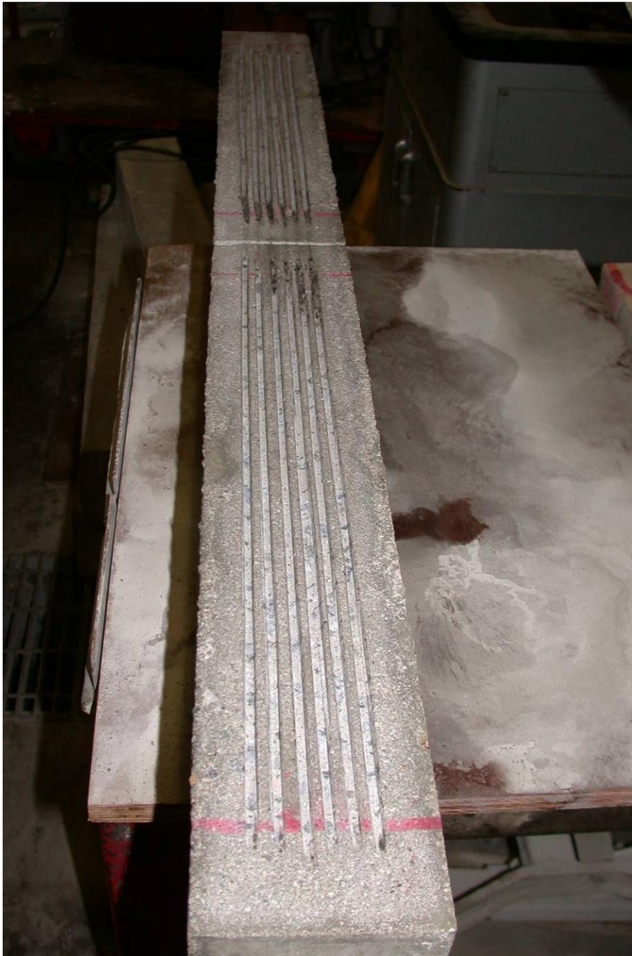
Figure 4.12 : Surface avec stries longitudinales
