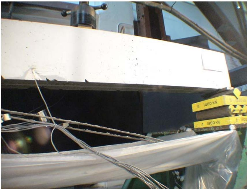
Figure 7.3 : MA10 après rupture – interface de rupture
