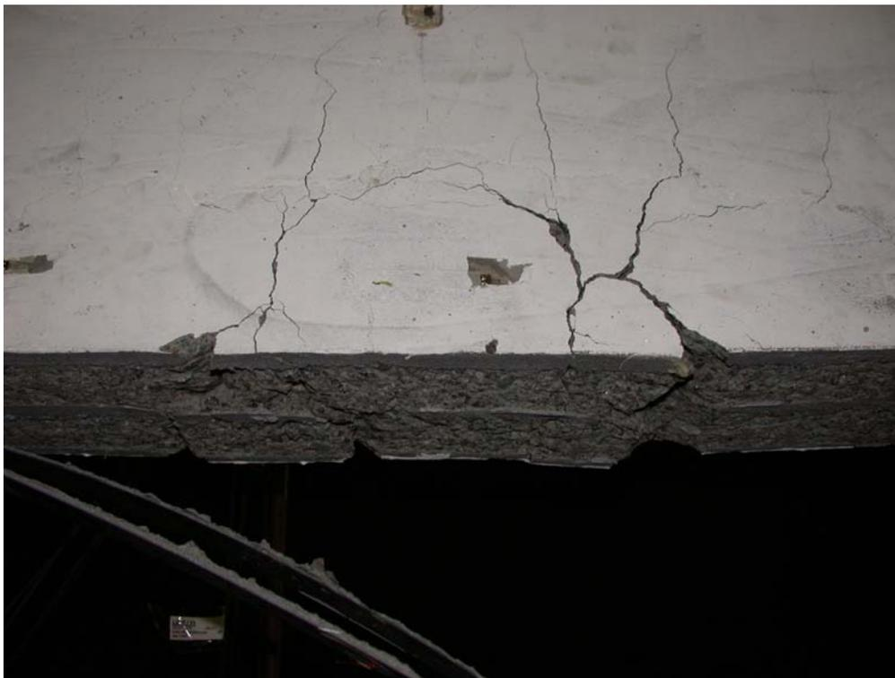
Figure 7.29 : MC10 – Mécanisme de fissuration
