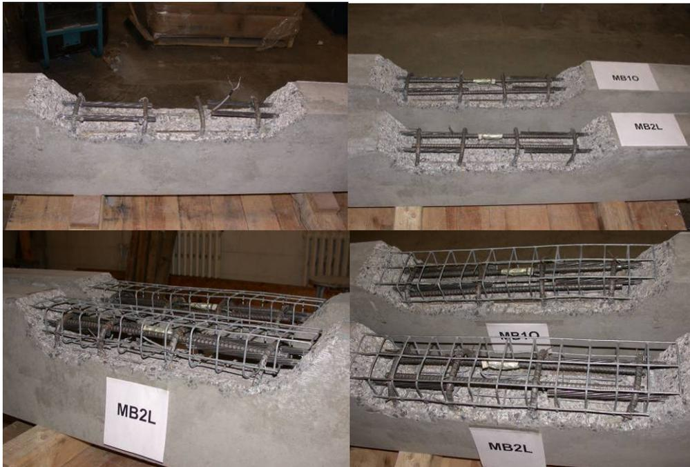
Figure 6.9 : Renforcement de la zone réparée pour les poutres MB10 et MB2L
