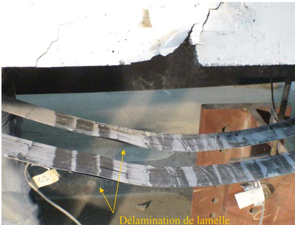
Figure 7.15 : Lamelles du composite après rupture
