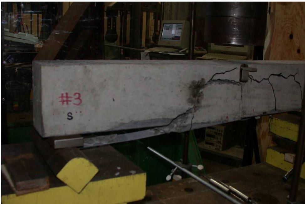
Figure 5.4 : Spécimen A3T après rupture
