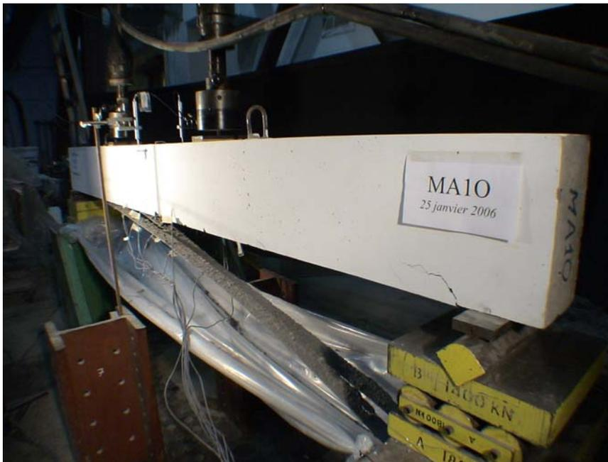
Figure 7.2 : MA10 après rupture – lamelles
