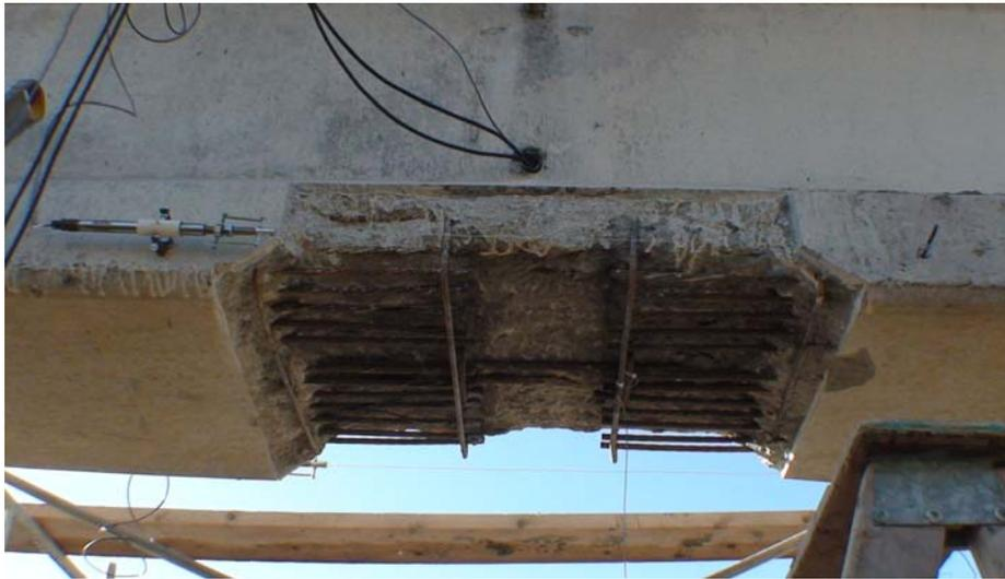
Figure 12.6 : Type d'endommagement des spécimens – Spécimen R1
