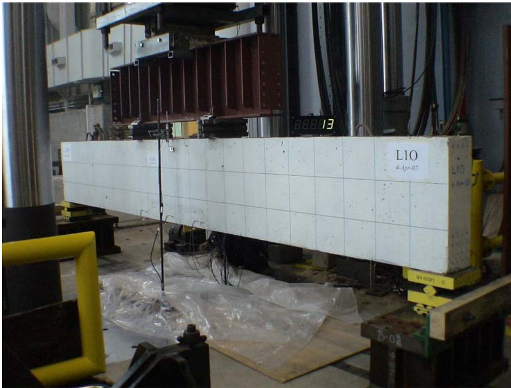
Figure 9.5 : Montage expérimental – Essai sur la poutre L10
