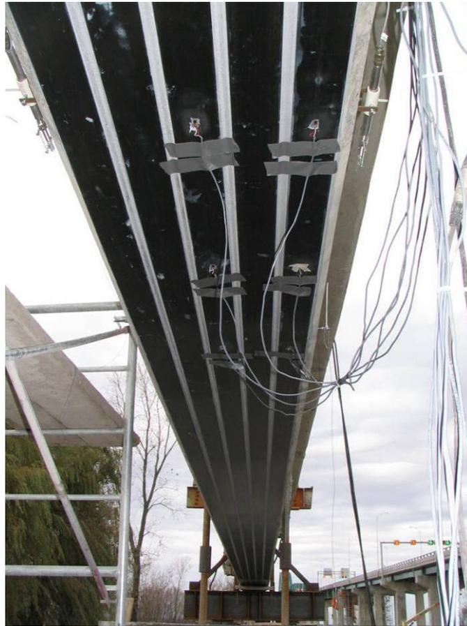
Figure 12.16 : Vue des jauges installées sur le matériau composite
