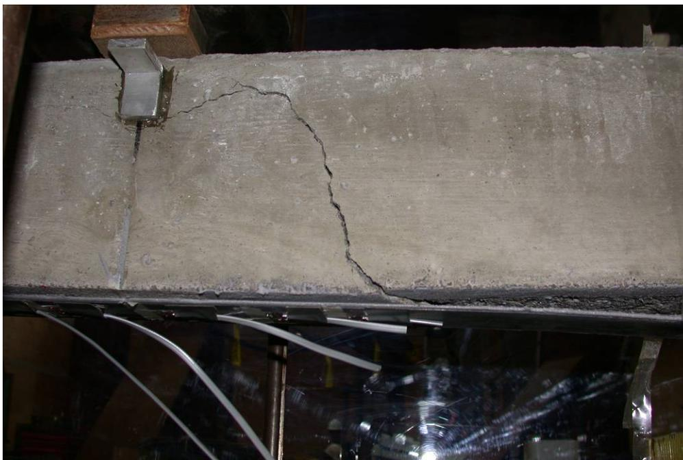
Figure 5.2 : Spécimen A10 après rupture
