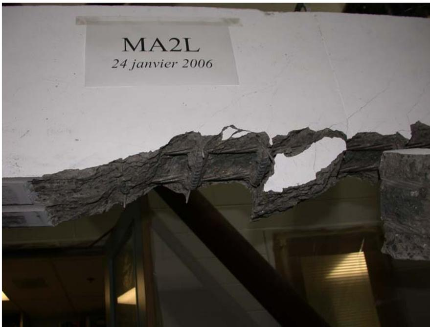
Figure 7.4 : Surface de rupture – plan d'initiation de rupture
