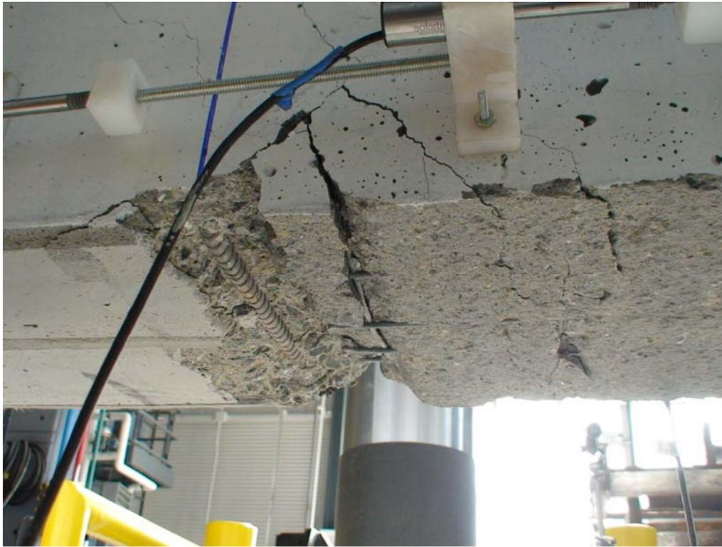
Figure 9.11 : Surface de rupture – plan d’initiation de rupture – L2B
