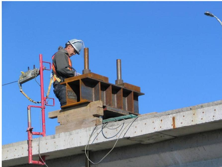
Figure 12.22 : Système de mise en charge
