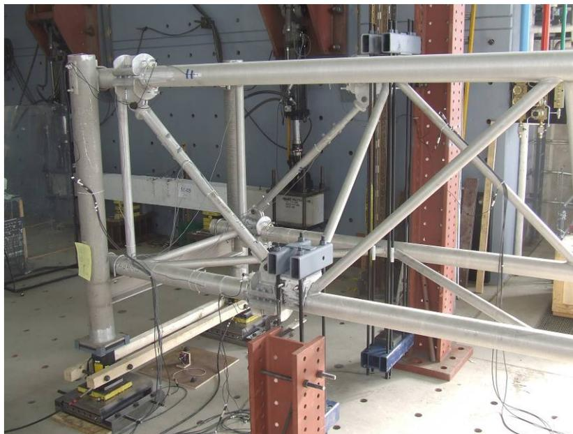
Figure 2 : Extrémité Sud – diagonales télescopiques
