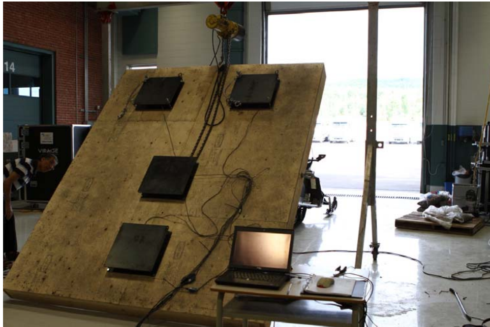
Figure 7 : Table de renversement des motoneiges.
