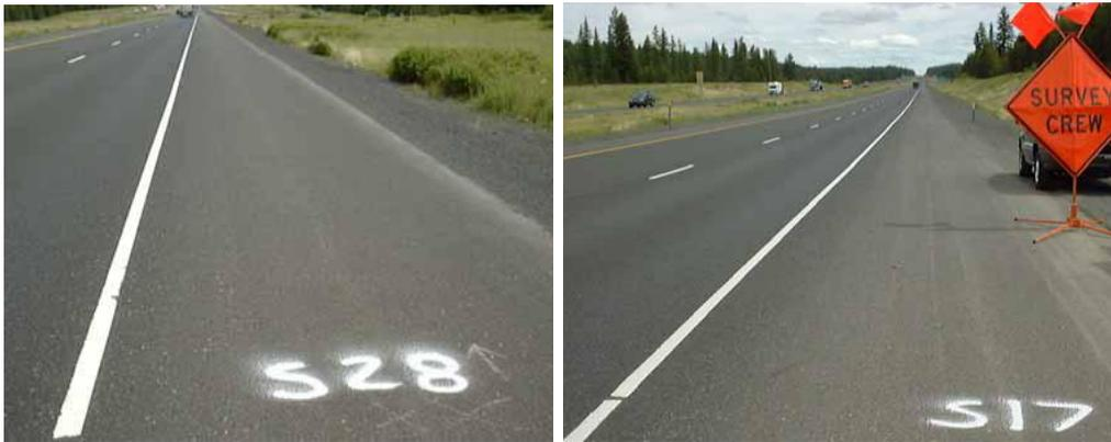
**Photo 3 - Photos du thermoplastique (à gauche) et du MMA (à droite) appliqués sur du bitume après la première période de maintenance hivernale**
