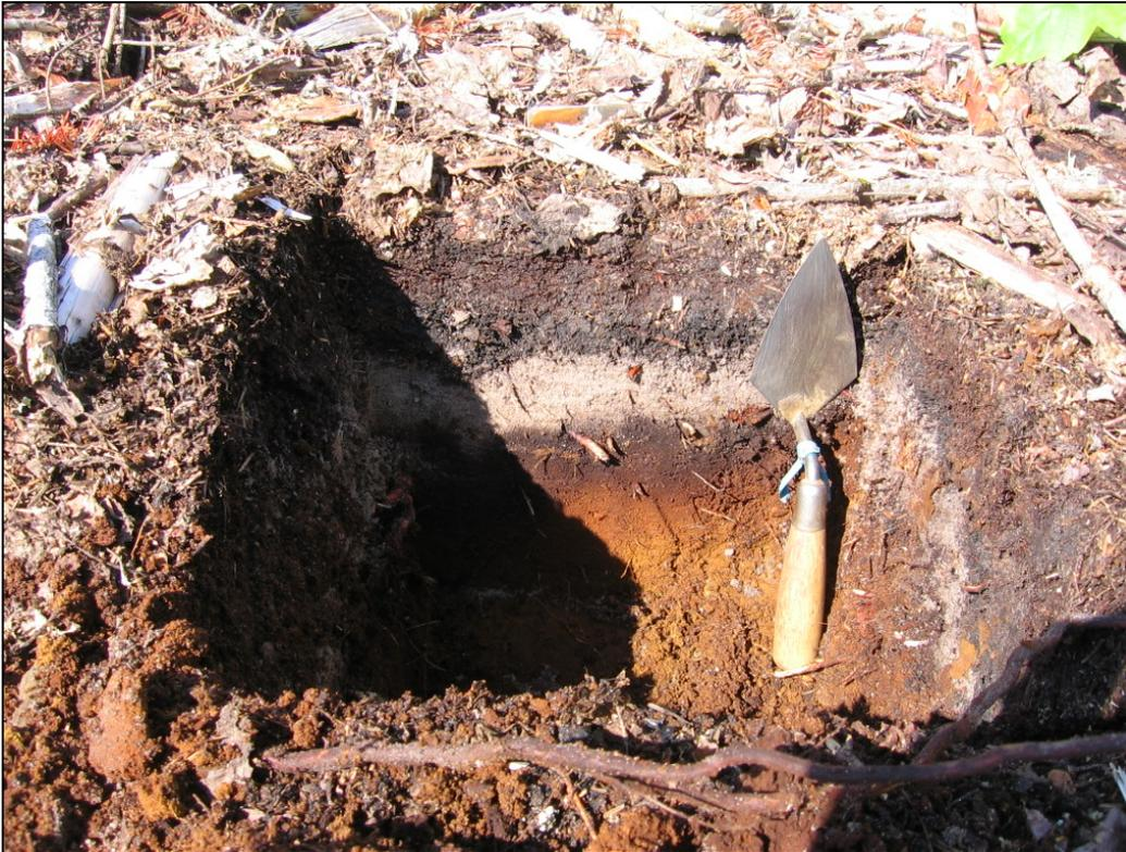
Photo 13 : Secteur 3, Ch. 166+940, paroi de sondage, podzol humo-ferrique, direction nord (photo n° 154-99-0665-068)
