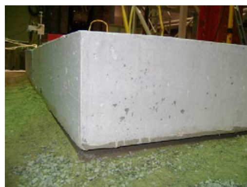
Figures 3.90 : Soulèvement des extrémités des dalles sous chargement de 400 kN
