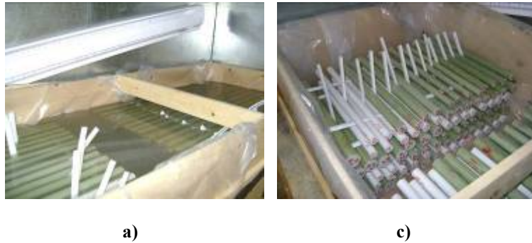
Figures 3.28 : Containers de vieillissement accéléré en chambre environnementale
