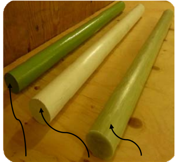
Figure 3.1 : Goujons d'acier, de PRFV polyester et vinylester
