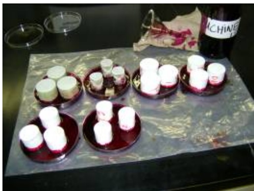
Figure 3.22 : Essai de pénétration à la fuchsine
