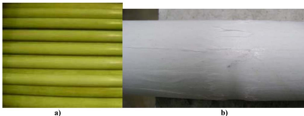
Figures 3.34 : Aspect des goujons en polyester conditionnés 90 jours en solution de NaOH à 3%
