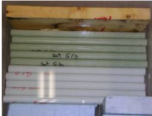
Figure 3.25 : Spécimens à saturation dans l'eau de 25,4 mm de diamètre
