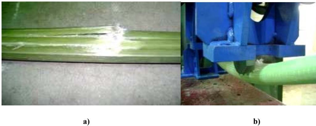
Figures 3.13 : Rupture en flexion par compression des goujons de PRFV (plus gros diamètres)
