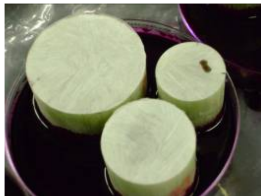
Figure 3.22 : Essai de pénétration à la fuchsine
