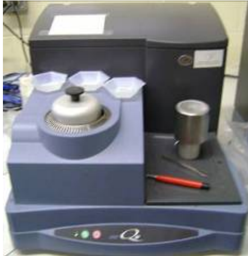
Figure 3.7 : Analyseur DSC Q10
