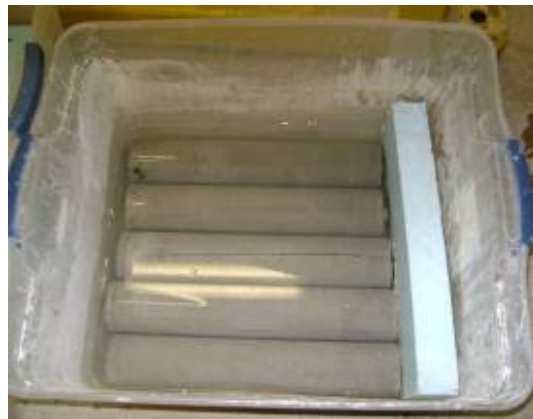
Figure 3.26 : Spécimens enrobés de béton à saturation dans l'eau
