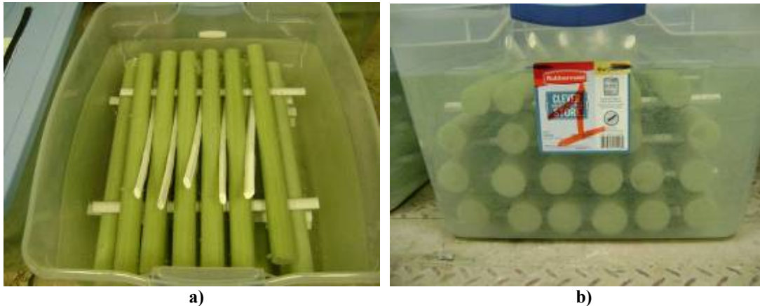
Figures 3.27 : Goujons de PRFV conditionnés en solution chimique
