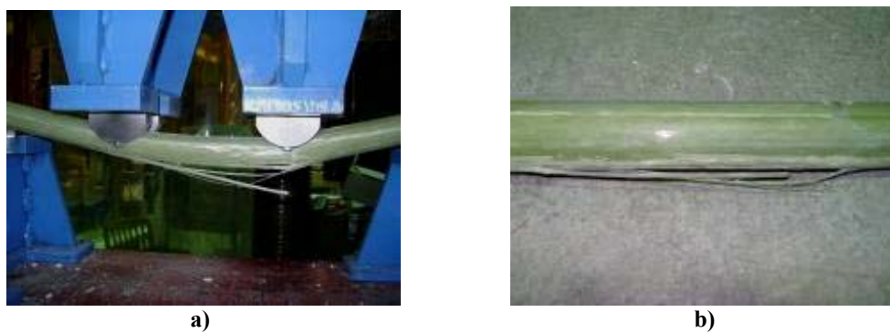
Figures 3.14 : Rupture en flexion par tension des goujons de PRFV (plus petits diamètres)
