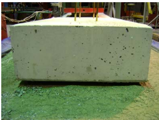
Figures 3.90 : Soulèvement des extrémités des dalles sous chargement de 400 kN
