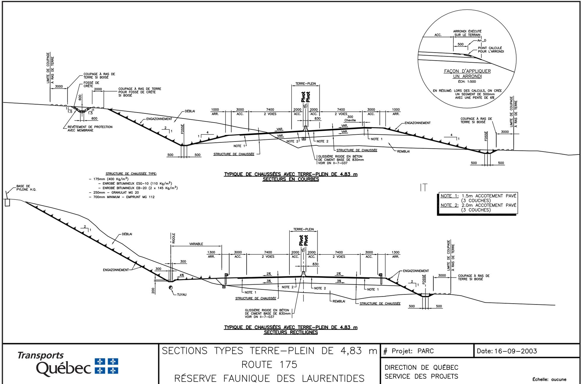
Figure 4.9 Sections types terre-plein de 4,83 m avec glissière rigide en béton.
