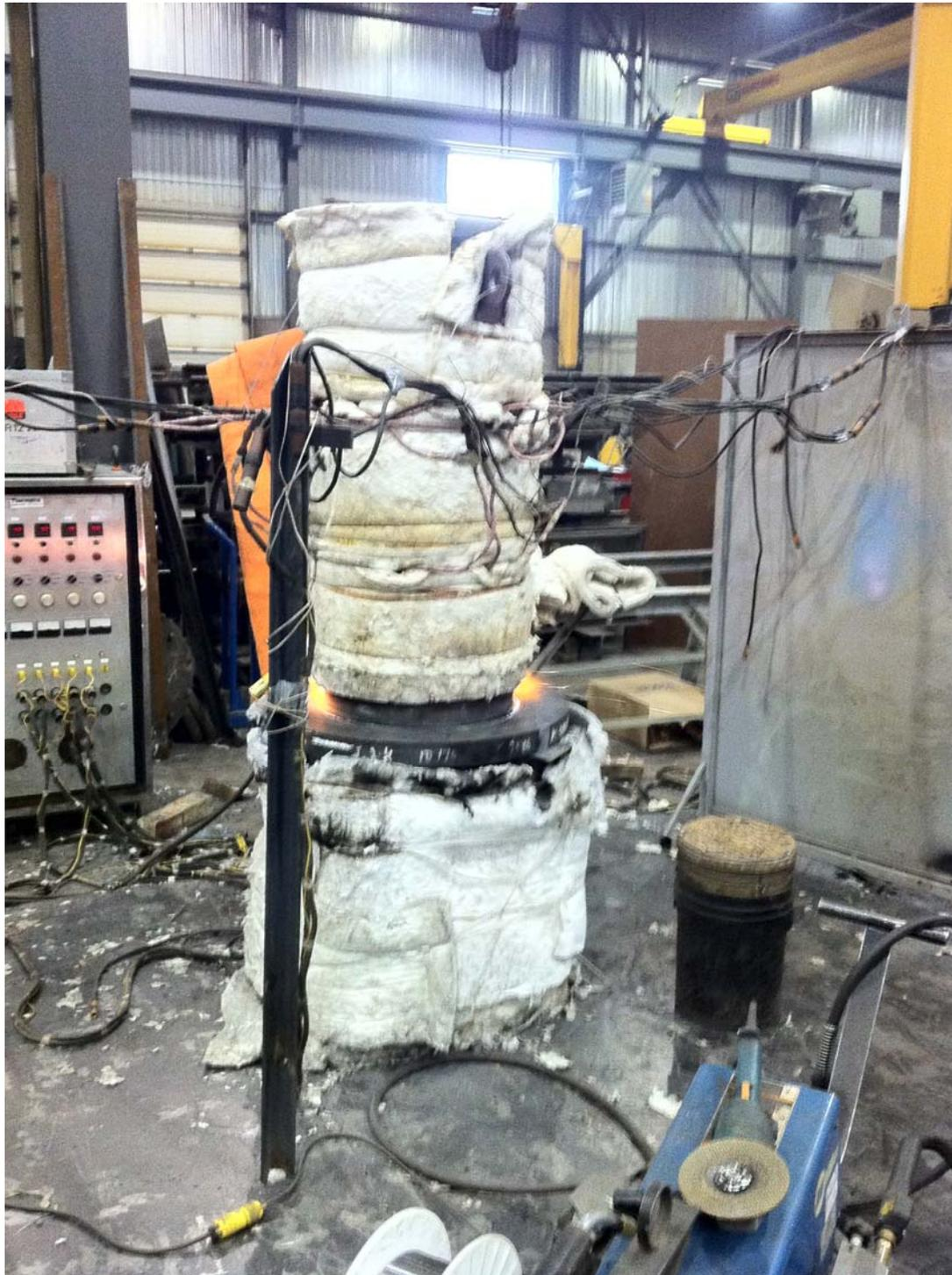
*Figure 23 – Contrôle de la température du pivot supérieur lors de la soudure de la bride d'assemblage*
