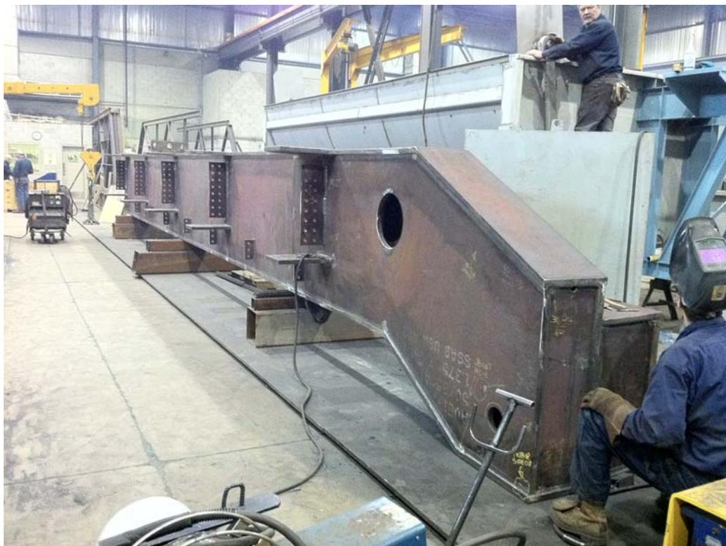
**Figure 24 – Assemblage d'une des deux poutres-caisson formant le tablier**
