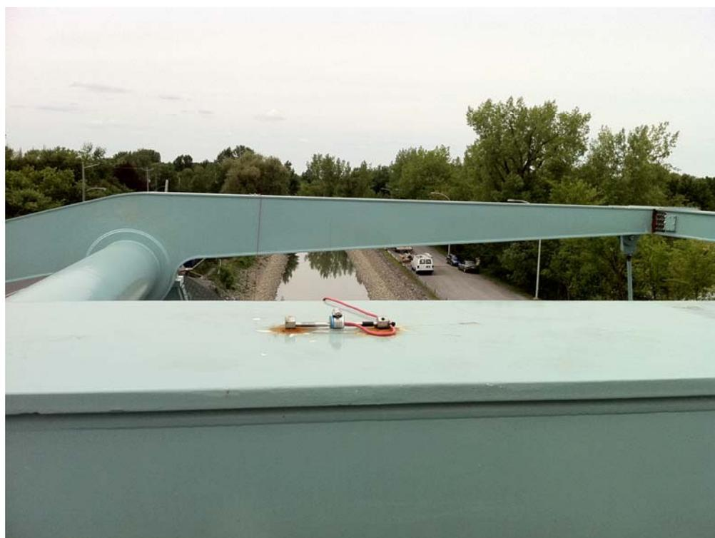
*Figure 34 – Corde vibrante installée aux fibres extrêmes des bras supérieurs*
