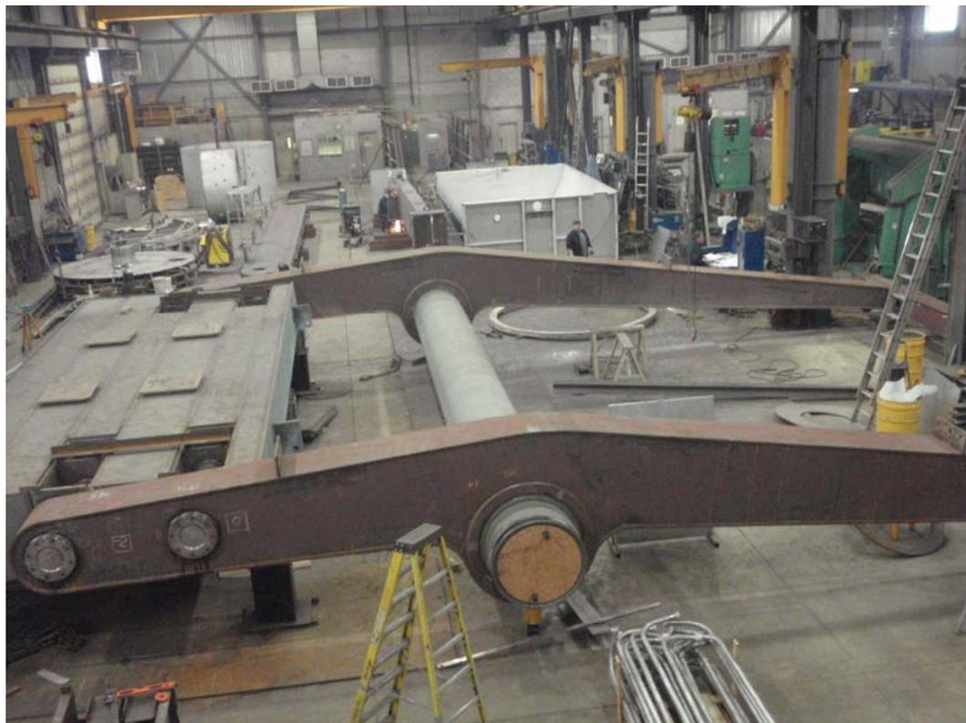
*Figure 20 – Pré-assemblage des éléments supérieurs en usine*
