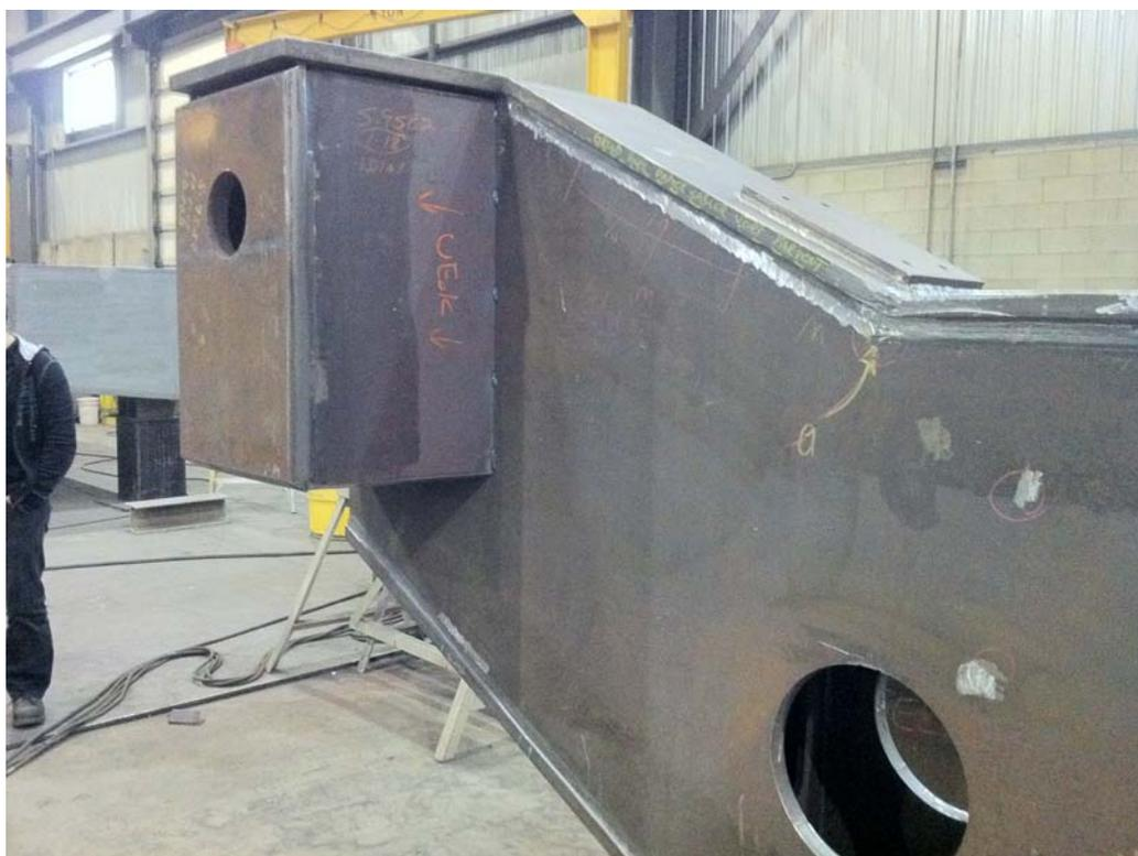
**Figure 25 – Poutre caisson – Extrémité du pivot inférieur et du point d'appui du cylindre**
