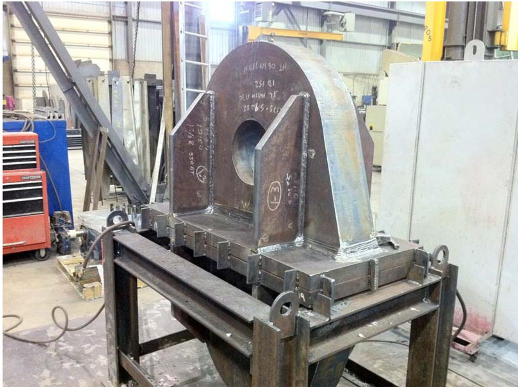
*Figure 21 – Assemblage de la chambre du pivot supérieur*
