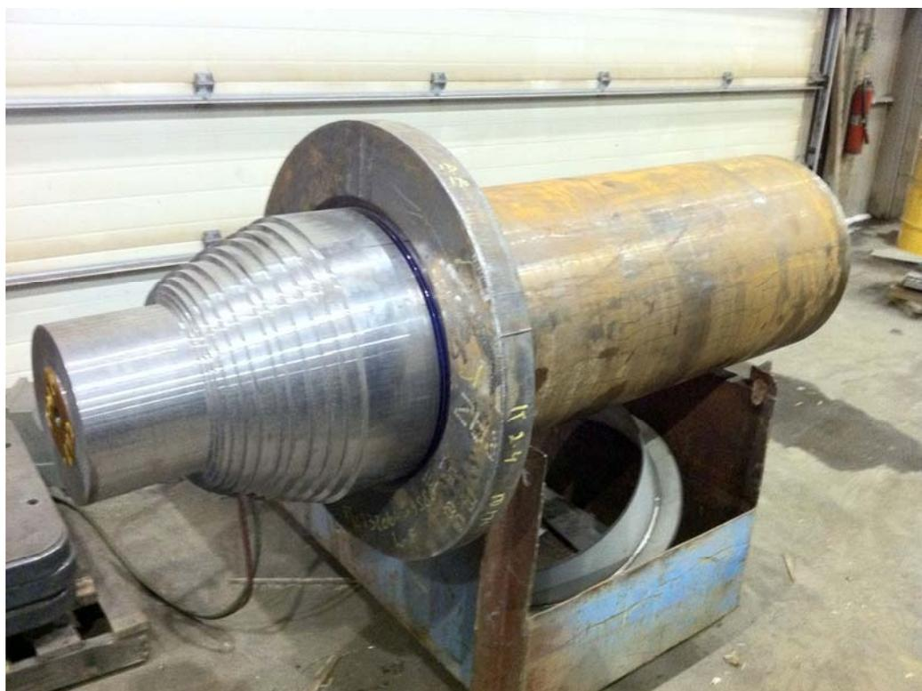
*Figure 22 – Pivot supérieur en cours d'usinage*
