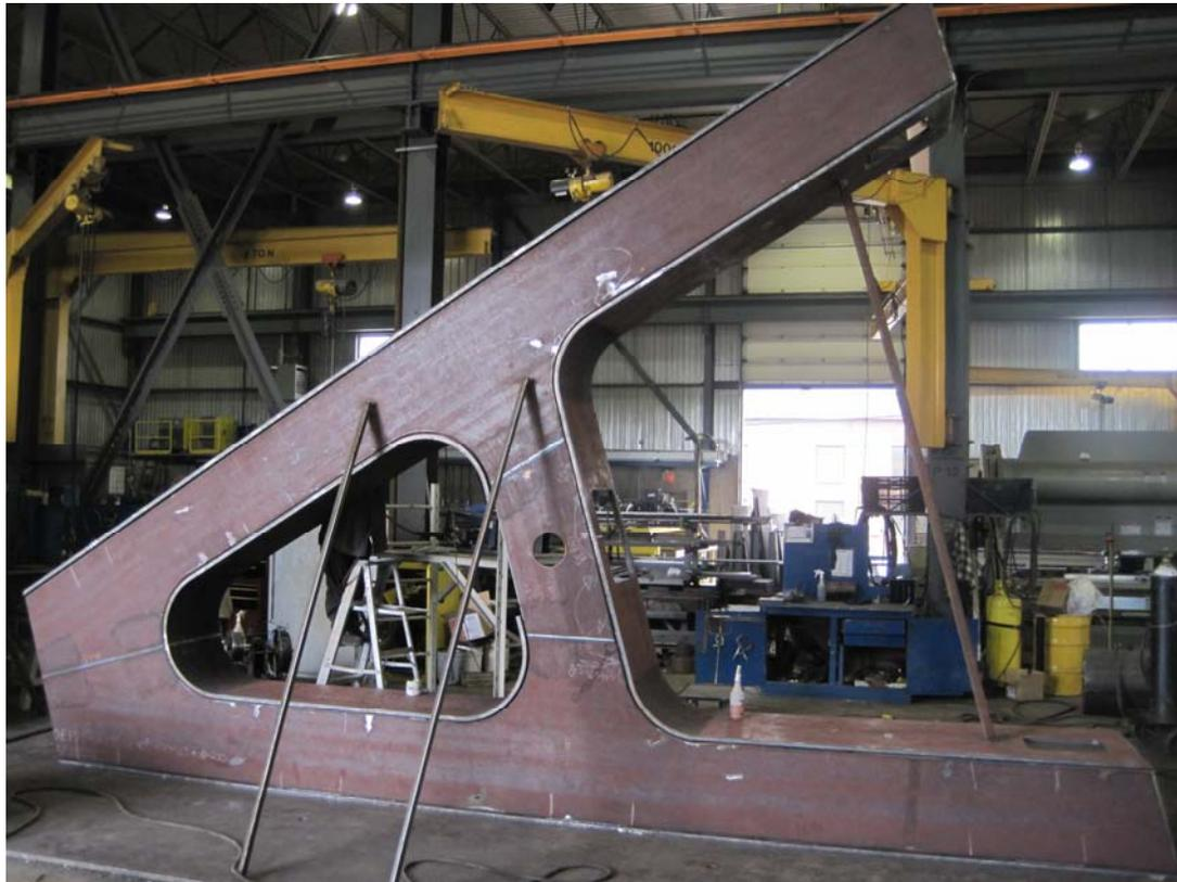
*Figure 26 – Un des supports en « A » en cours d'assemblage*
