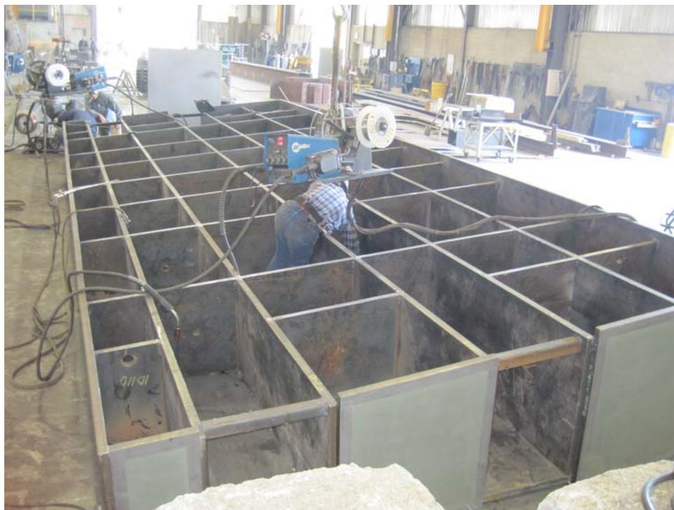
**Figure 17 – Contrepoids en cours d'assemblage**
