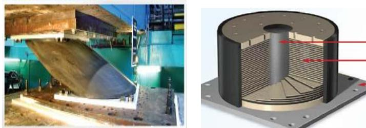
Figure 2 – Isolateur en élastomère fretté avec noyau de plomb (photo DIS)
