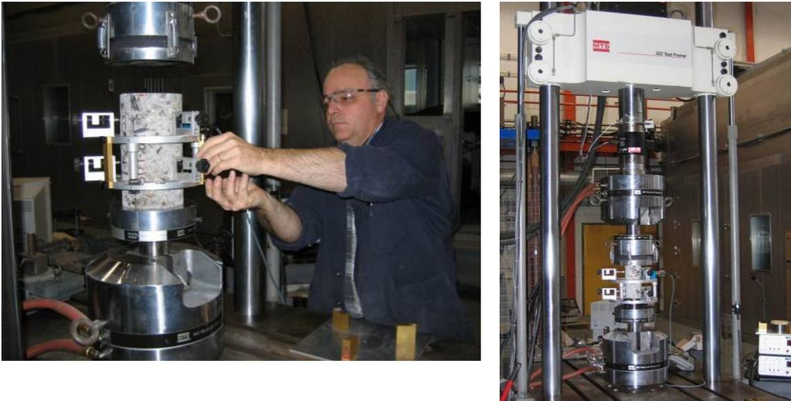
Figure 14 : Montage et instrumentation utilisés pour l'essai du Stiffness Damage Test.
