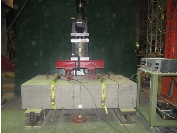
Figure 4. Le montage de chargement des dalles pour simuler le passage de véhicule au laboratoire.
