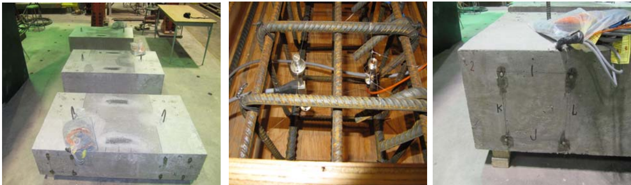
Figure 2. Dalle en béton avec instruments de mesure de l'expansion. A gauche : dalles en béton fabriquée au laboratoire; au milieu : détail des armatures et extensomètre à corde vibrante et à fibre optique; à droite : plots Demec.
