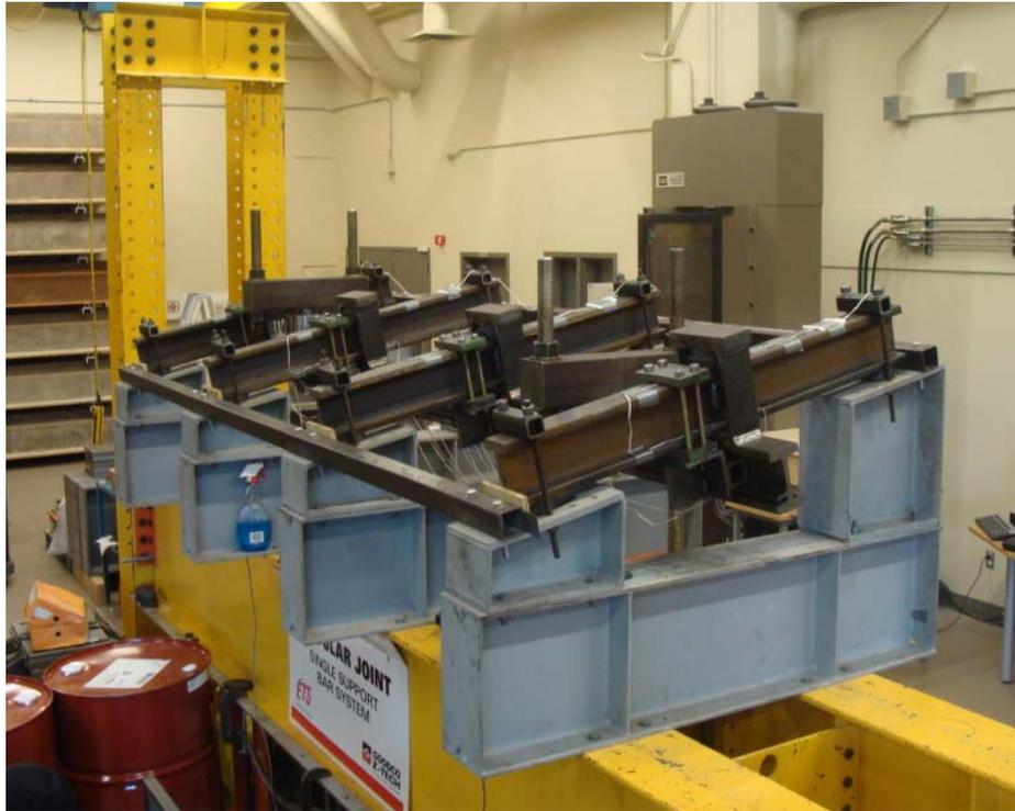
Figure 3 –Spécimen instrumenté installé sur le bâti d’essai spécialement conçu
