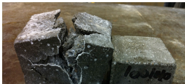
Figure 4 Bloc de MBE très expansif et bloc de MBE de ciment Portland
