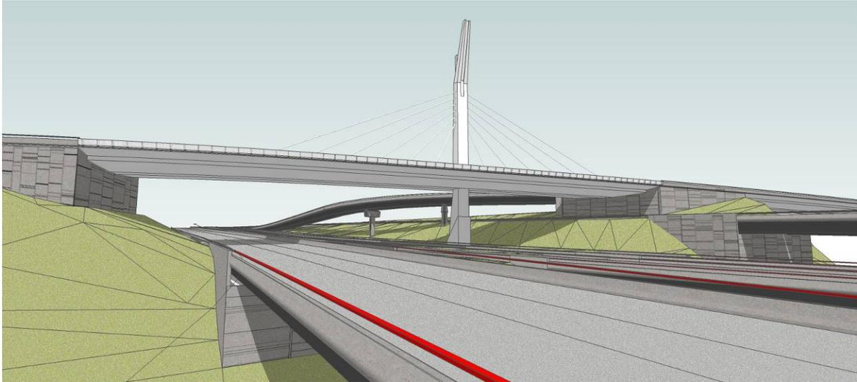
Le tablier est supporté par un caisson central en acier peint blanc qui s'amincit vers l'extérieur et dont la portée est prolongée par des consoles apparentes, sous les trottoirs. Ces éléments structuraux deviennent ici des composantes architecturales de l'ouvrage d'art, en créant un rythme et en conférant une légèreté à l'ensemble.
