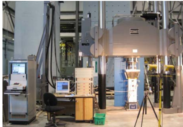
Figure 1: Dispositif expérimental des essais sur poteaux
