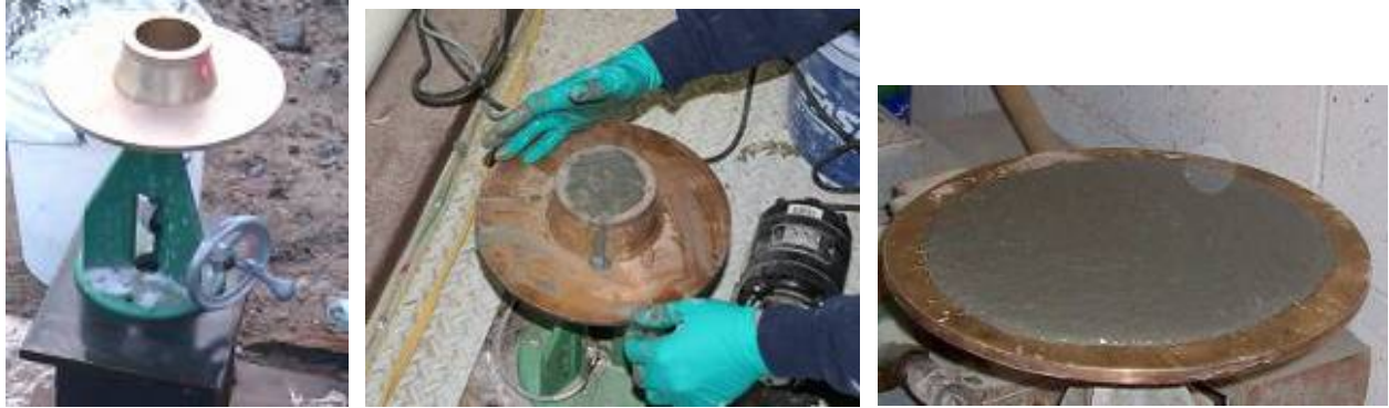
Tests sur place pour vérifier la fluidité du mélange.
