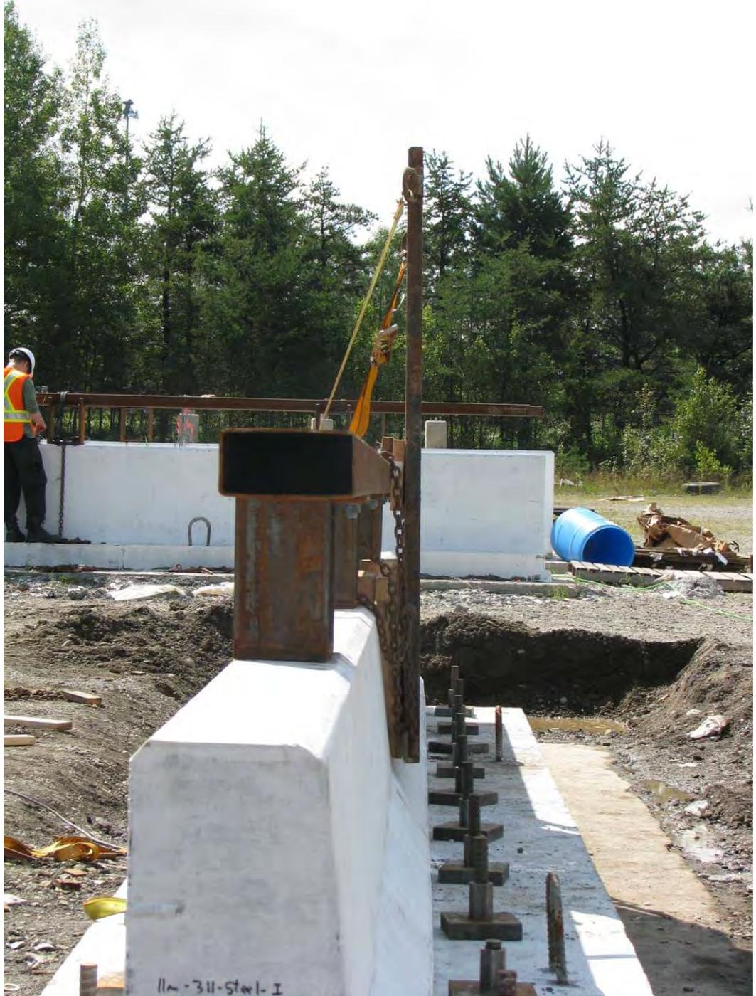
Figure 2.44 (suite): Plaque d'acier fixée et ancrage du spécimen 311 au banc d'essai
