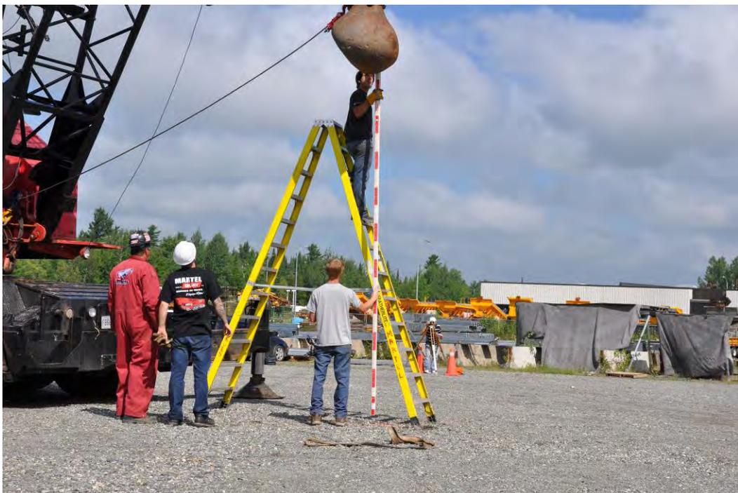
Figure 2.46 (suite): Ajustement de la hauteur de chute de la boule d'acier
