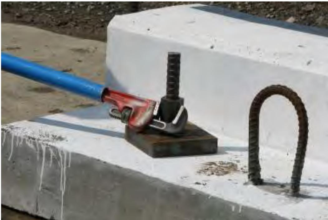
Figure 2.40: Ancrage du spécimen au banc d'essai
