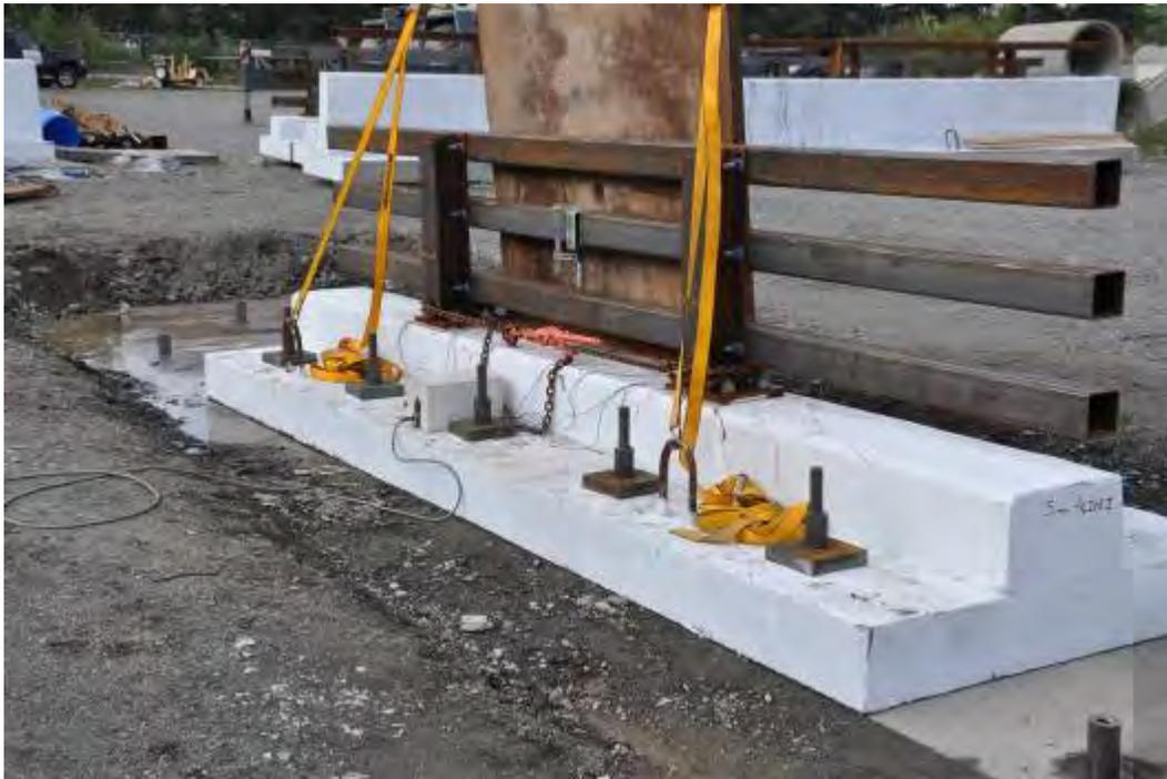
Figure 3.5: Réseau de fissuration du spécimen 210-Acier-5m-I après un premier essai à  $h=3,0$  m
