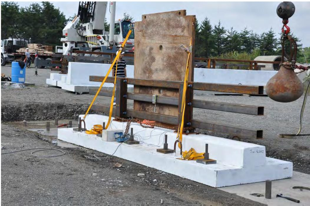
Figure 2.42: Plaque d'acier fixée à un spécimen de type 210
