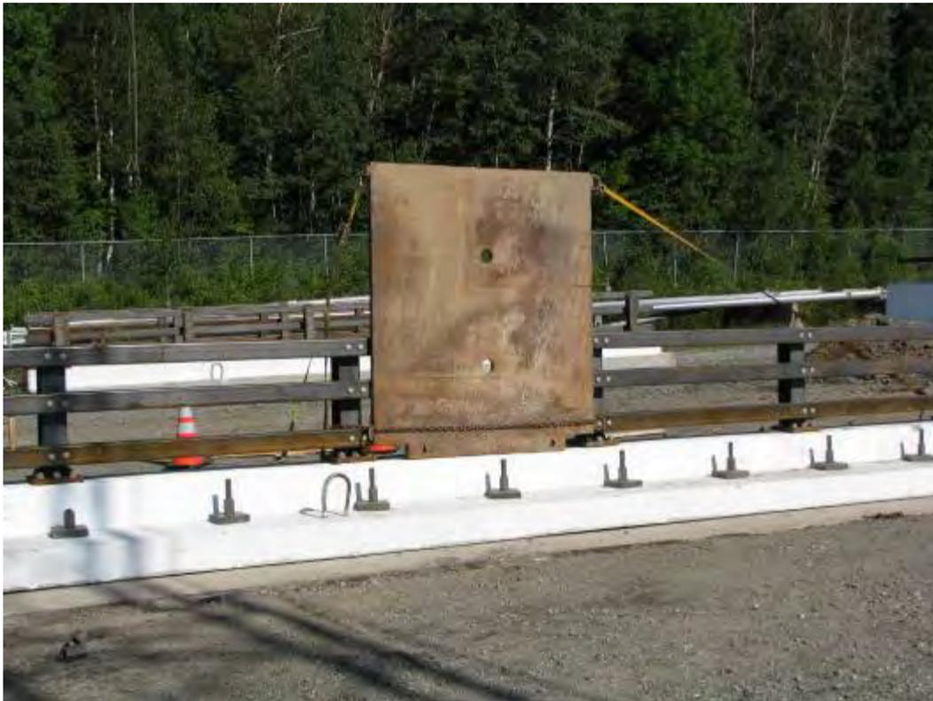
Figure 2.41: Spécimen de type 210 ancré au banc d'essai
