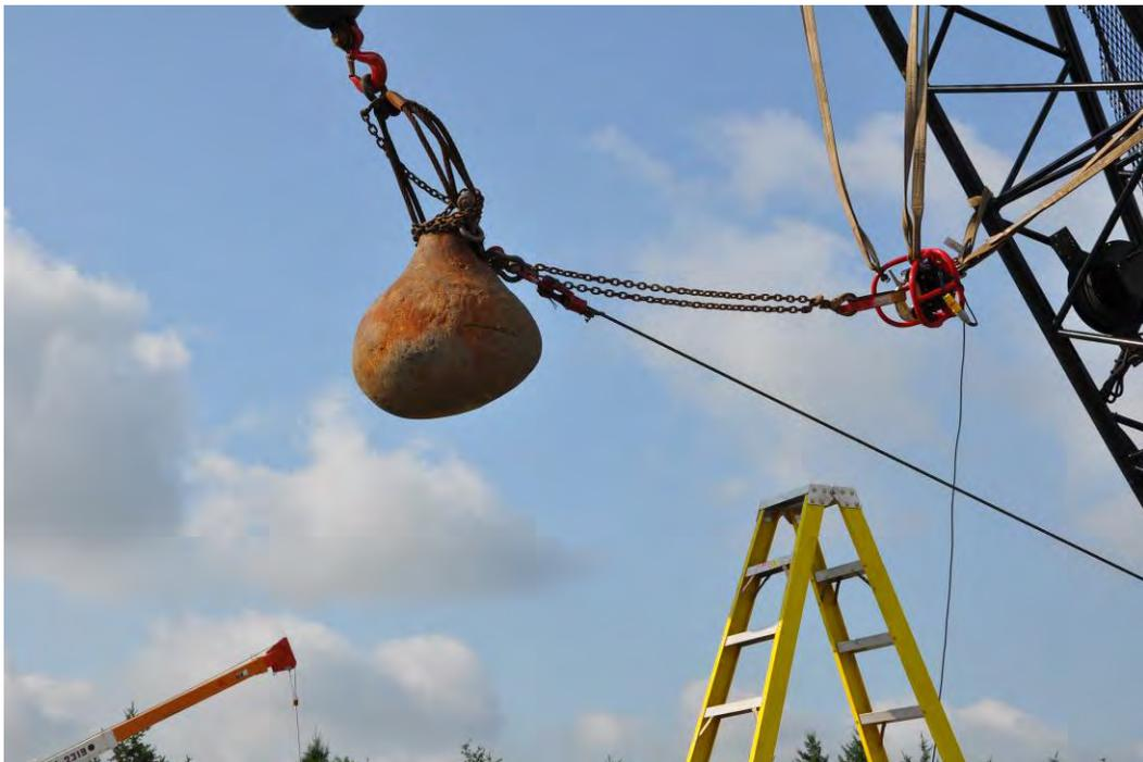
Figure 2.45: Détails du système de poulie utilisé pour retenir et relâcher la boule d'acier
