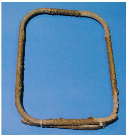
Figure 2.7: Étrier fermé en PRFV des spécimens de type 210 (type G1)
