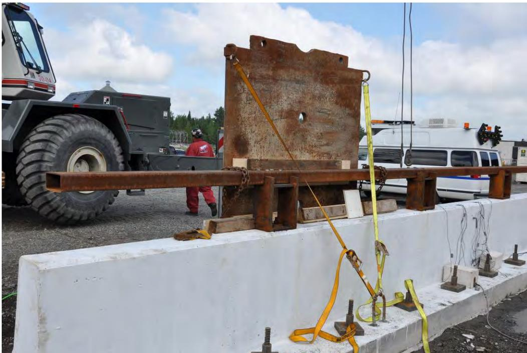
Figure 2.44: Plaque d'acier fixée et ancrage du spécimen 311 au banc d'essai
