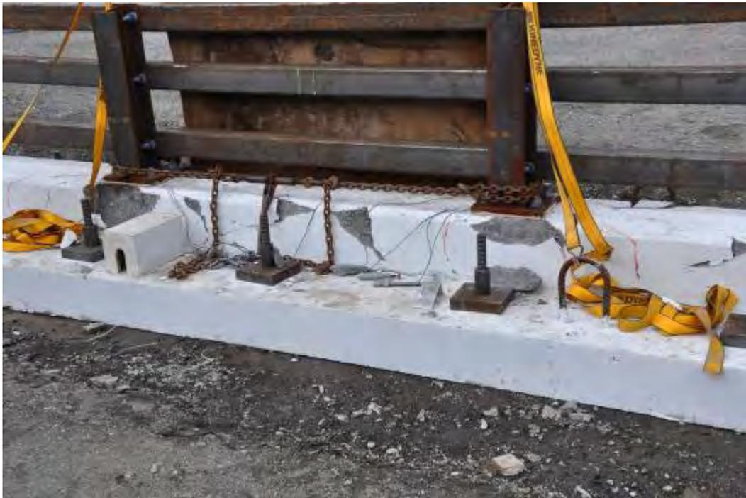
Figure 3.6: Réseau de fissuration du spécimen 210-Acier-5m-I après un deuxième essai à  $h=2,06$  m
