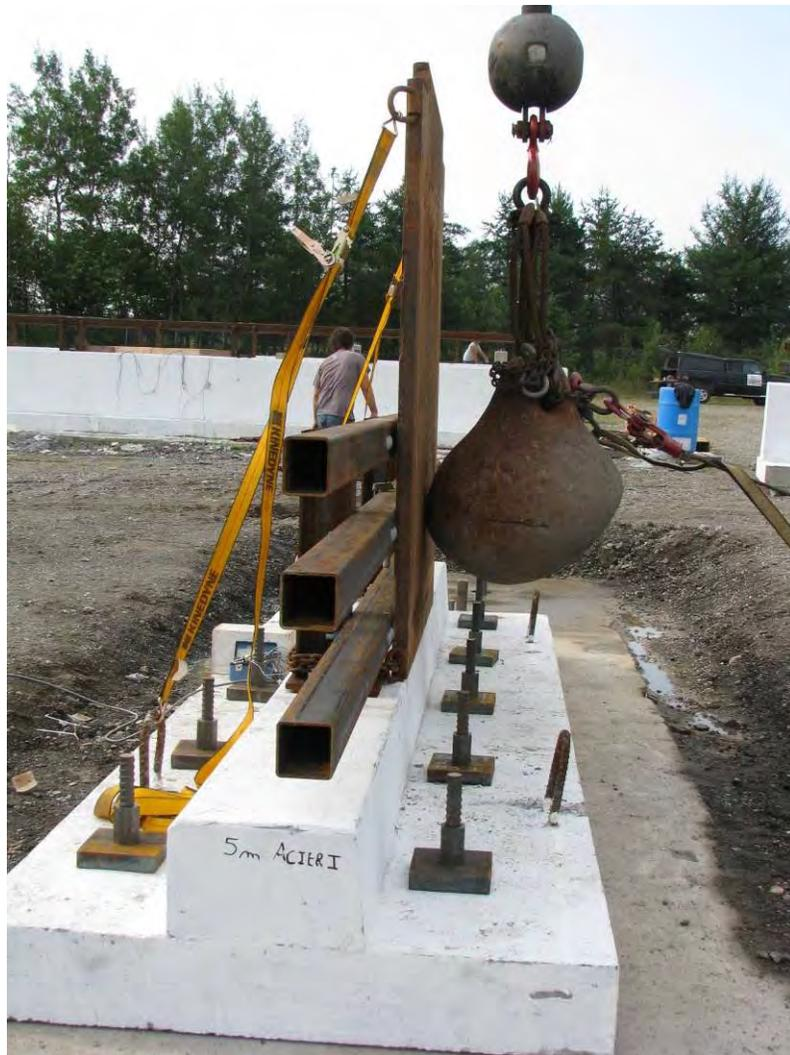
Figure 2.46 (suite): Ajustement de la hauteur de chute de la boule d'acier
