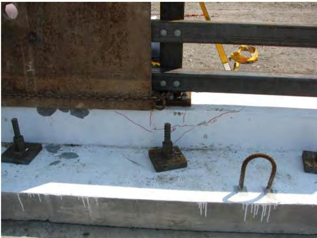
Figure 3.8: Réseau de fissuration du spécimen 210-Acier-5m-II après un essai à  $h=3,0$  m
