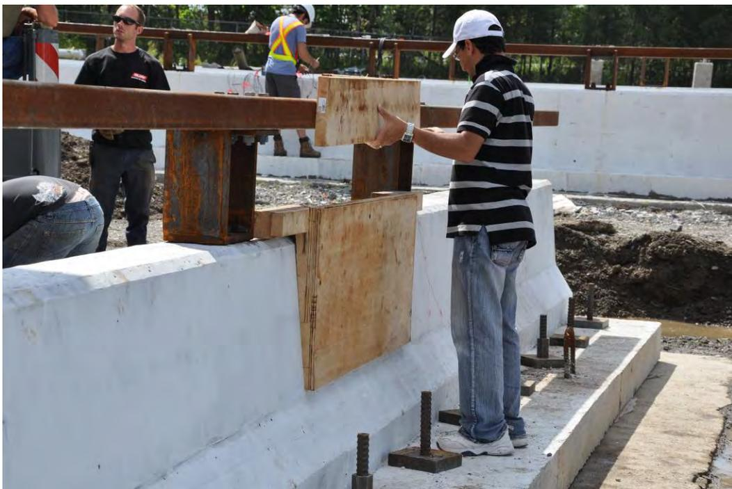
Figure 2.43: Pièces de bois distribuant uniformément la charge d'impact de la plaque d'acier au spécimen de type 311
