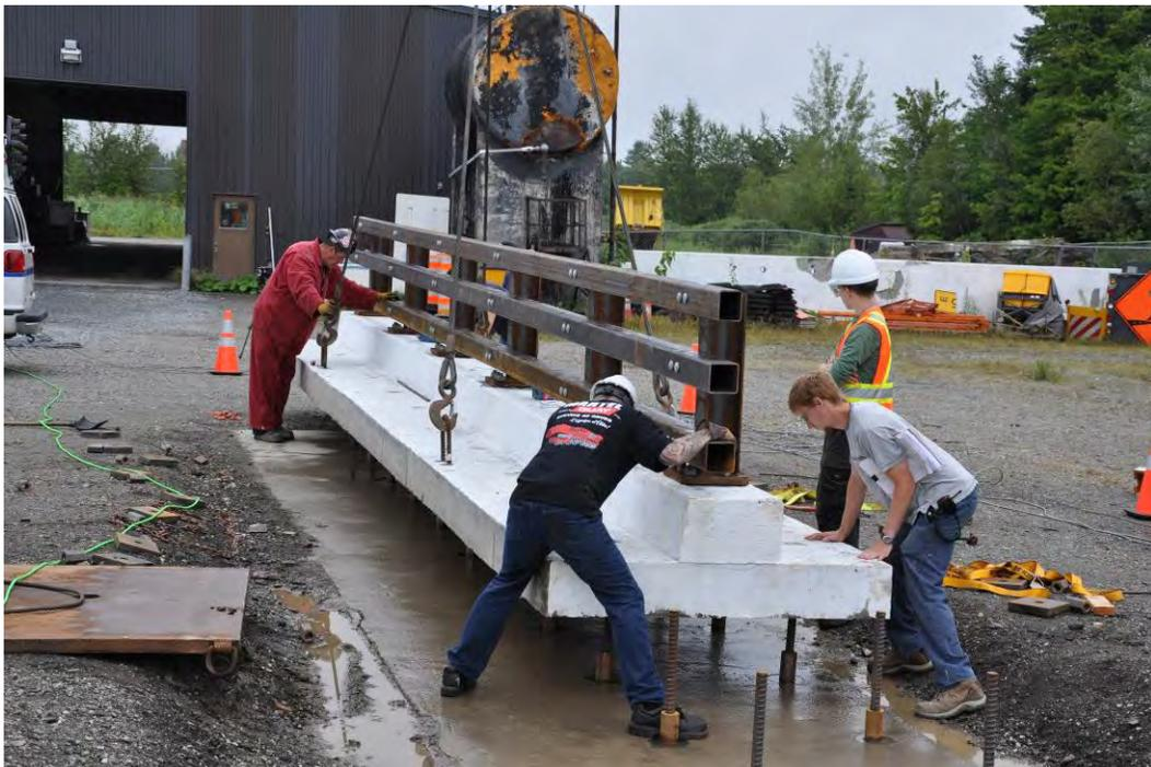
Figure 2.39: Installation des spécimens sur le banc d'essai
