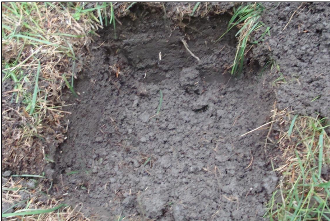
Photo 4 : projet 154-70-0012, municipalit  de Saguenay, autoroute entre Chicoutimi et La Baie, sondage exploratoire en cours de fouille, secteur Chemin St-Roch (contrat #1).
