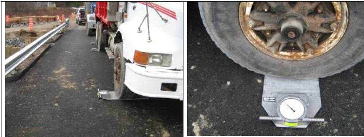
**Figure 8. Dimensions et charges des essieux des deux camions utilisés lors des essais statiques et dynamiques**
