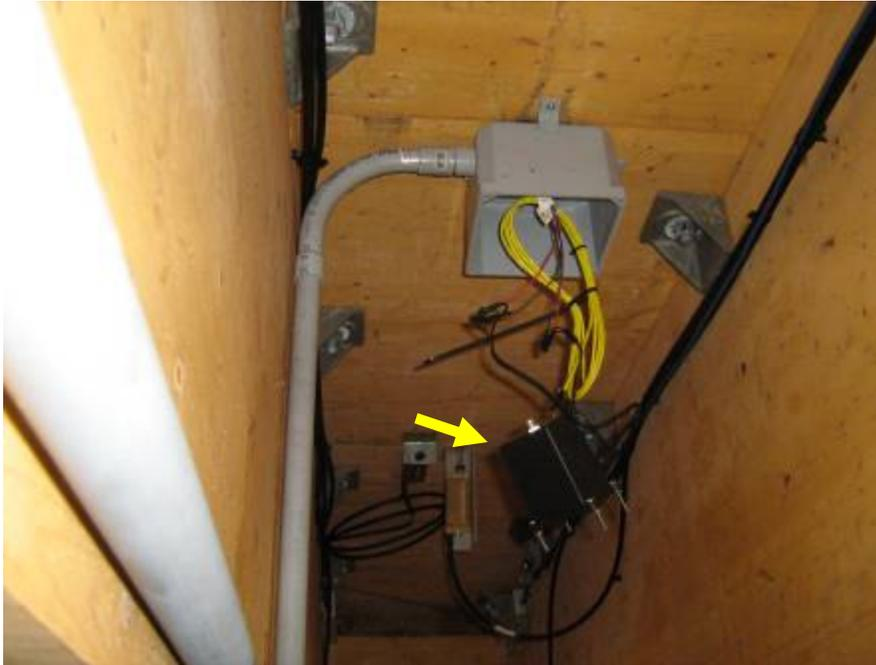
**Figure 6. Extensomètres installés sous le pont entre deux panneaux de platelage adjacents**
