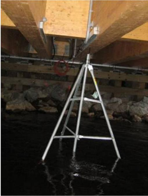
**Figure 8** Vue du dispositif de mesure de la déflexion utilisé lors de l'essai de chargement du 06-10-2010
