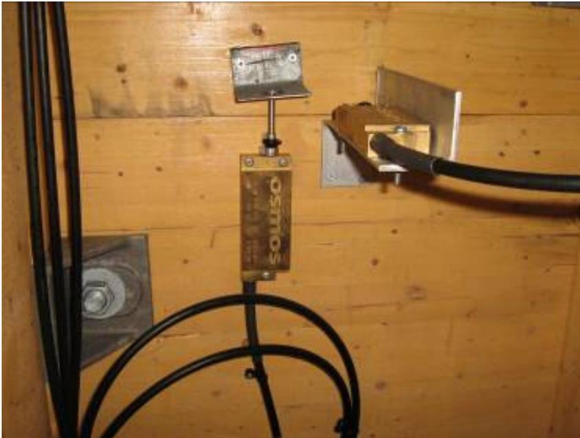
Figure 7      Extensomètres installés sous le pont entre deux panneaux de platelage adjacents
