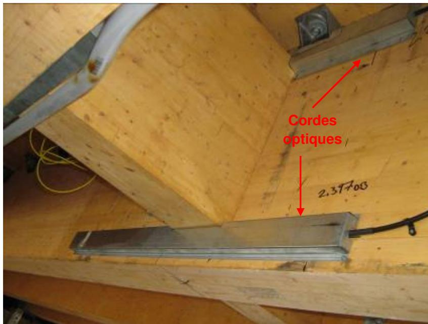
**Figure 5. Capteur d'humidité humid-bois 1**
