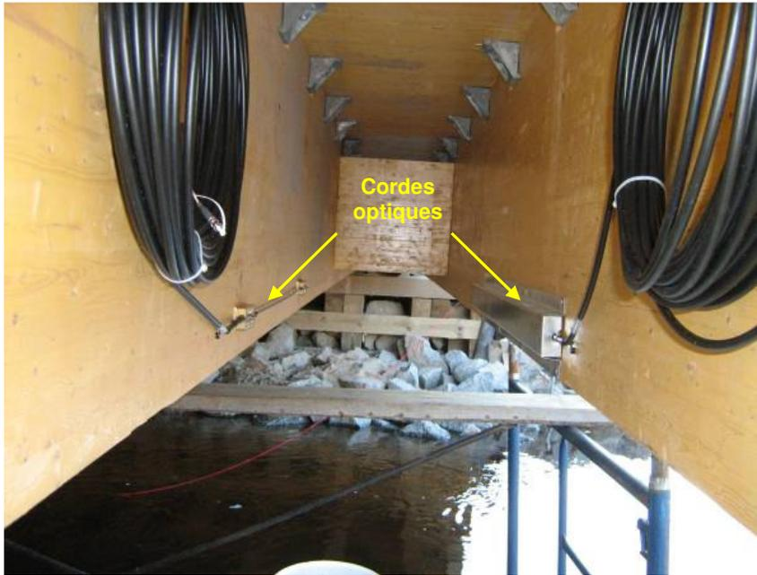
Figure 4 Cordes optiques sur les poutres 5 et 6 installées au tiers de la portée
