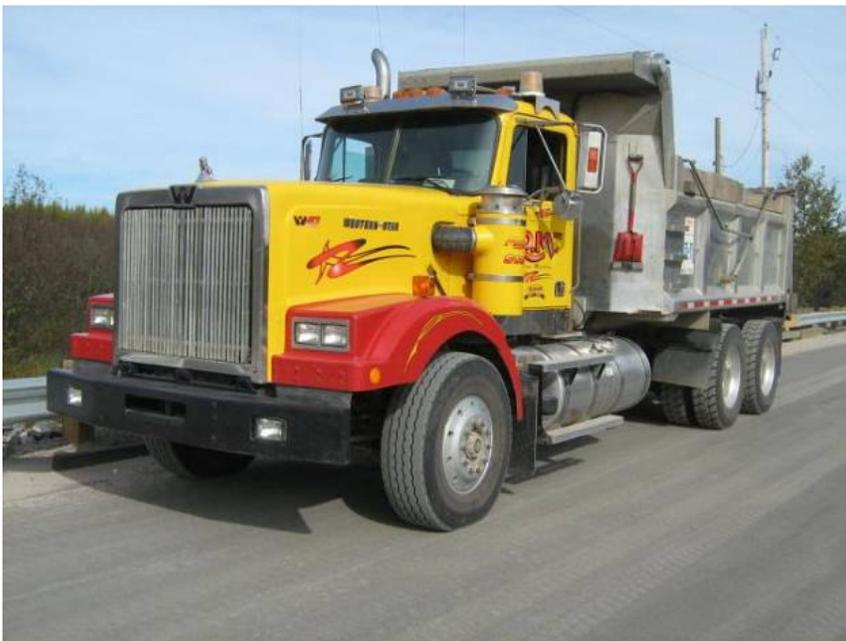
**Figure 11** Photos des camions utilisés pour les essais de chargement (deuxième série)
