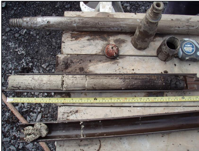
Photo 5 : Exemple type d'un échantillon de marne dans une cuillère fendue, sous-opération MTL09-23-1-2P (MTL09-23-1-NUM1-23)
