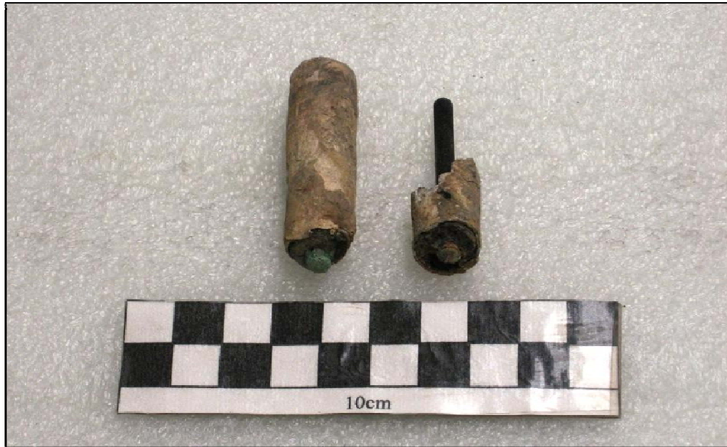
Photo 36 Site BhFI-26, électrodes de carbone avec enveloppe en céramique, lot A1 ouest.
