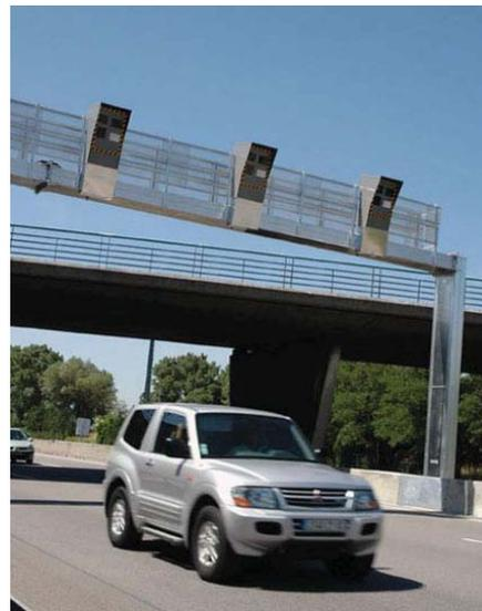
L'aménagement d'un photo-radar (figure 42) peut également contribuer, d'une façon significative, à la réduction de la vitesse pratiquée dans ce secteur névralgique, car la vitesse affichée durant les heures hors pointe est rarement respectée. Le PMV, installé en amont des photo-radars, pourrait indiquer la limite de vitesse à la place de la petite signalisation latérale. Cette vitesse pourrait être variable, selon les conditions de circulation et contrôlée par les photo-radars.
