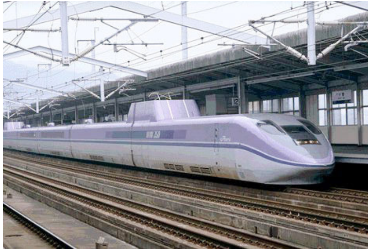
Figure 5.7 : Trains à haute vitesse japonais avec des pantographes couverts
