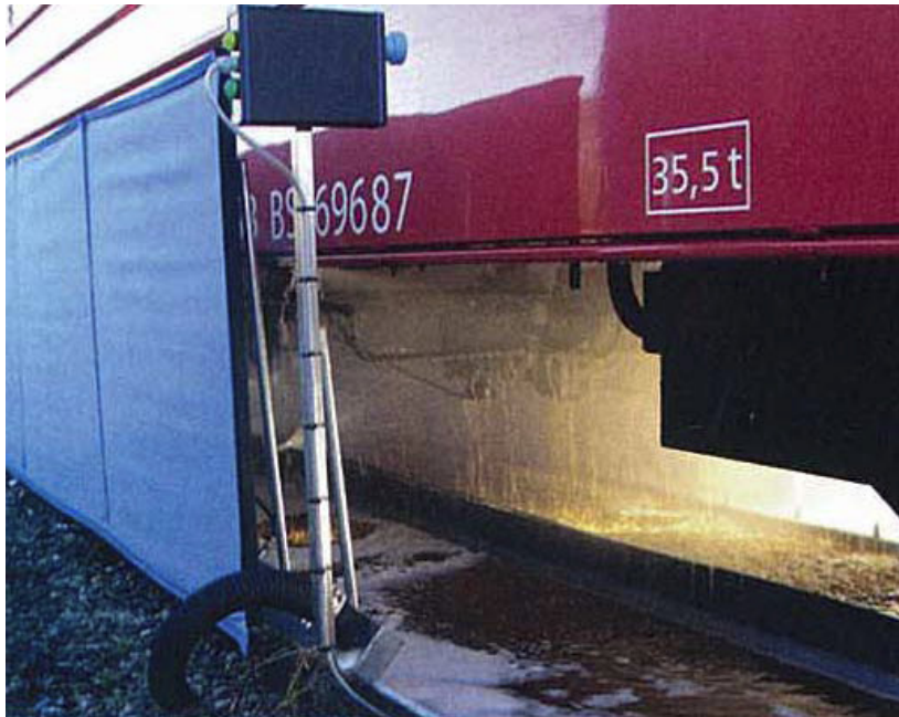
FIGURE 24 : Équipement de dégivrage (IRJ), [17]
