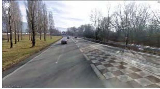
À l'approche d'un TC, les véhicules circulant sur la bretelle d'accès ont obligation de s'arrêter au rouge du feu tricolore positionné sur la bretelle d'accès. La voie réservée, quant à elle, utilise le feu spécifique des lignes de tramway (le R17) positionné sur l'A48 en amont de l'intersection. De fait, les automobilistes circulant sur les deux voies de gauche de l'autoroute ne se sentent pas concernés par cette signalisation.
