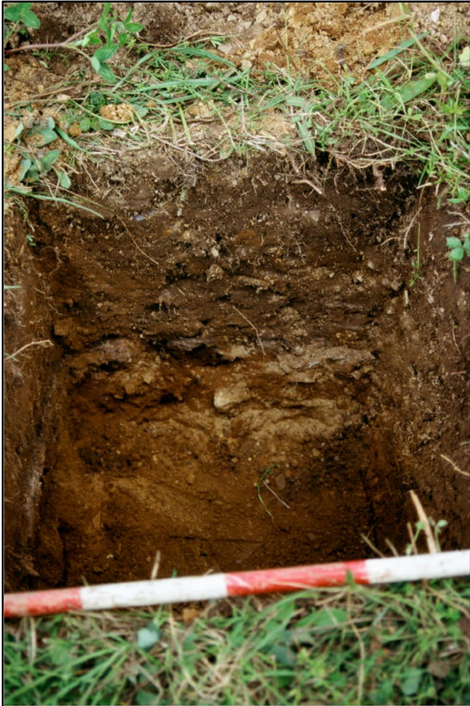
Photo 28 : Paroi stratigraphique d'un sondage localisé du côté sud-ouest du pont dans le secteur 2, au km 2+300 sur la route 293, en direction nord (20-3373-8611-A-D1-14)
