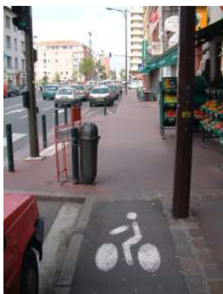
Aménagement cyclable intégré sur trottoir avec conflits possibles
