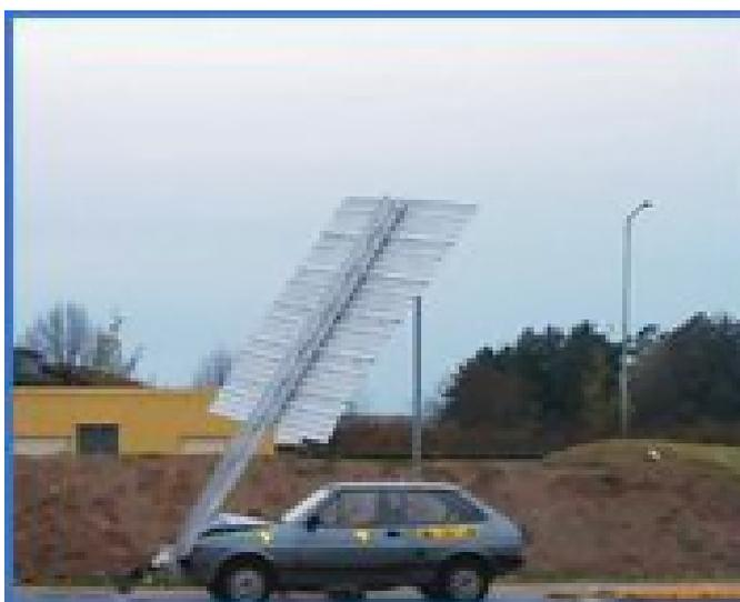
*Démonstration du fonctionnement d'un support détachable
