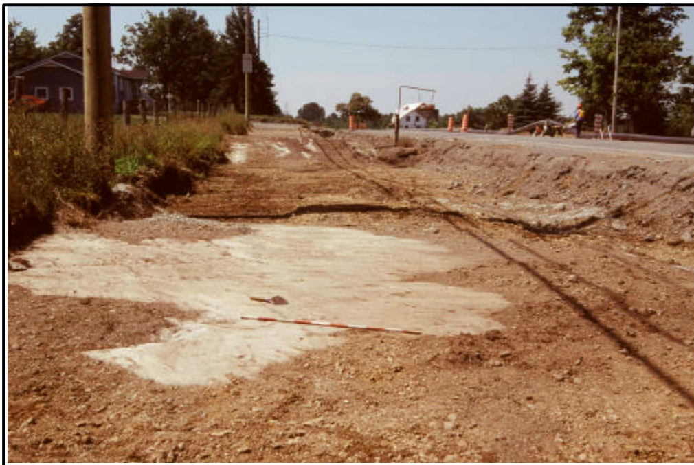
Photo 5 : Surface de la roche en place, de type schiste à chlorite, à très faible profondeur (20-5373-9150-B-D1-3).
