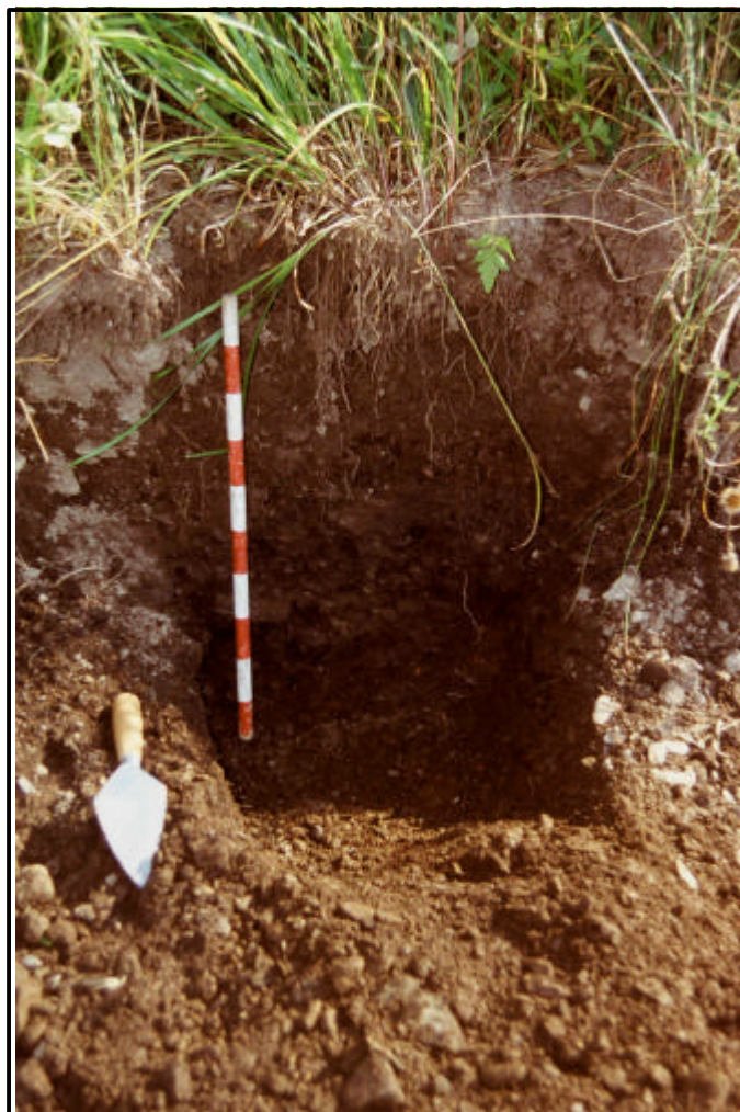
Photo 5 : Surface de la roche en place, de type schiste à chlorite, à très faible profondeur (20-5373-9150-B-D1-3).
